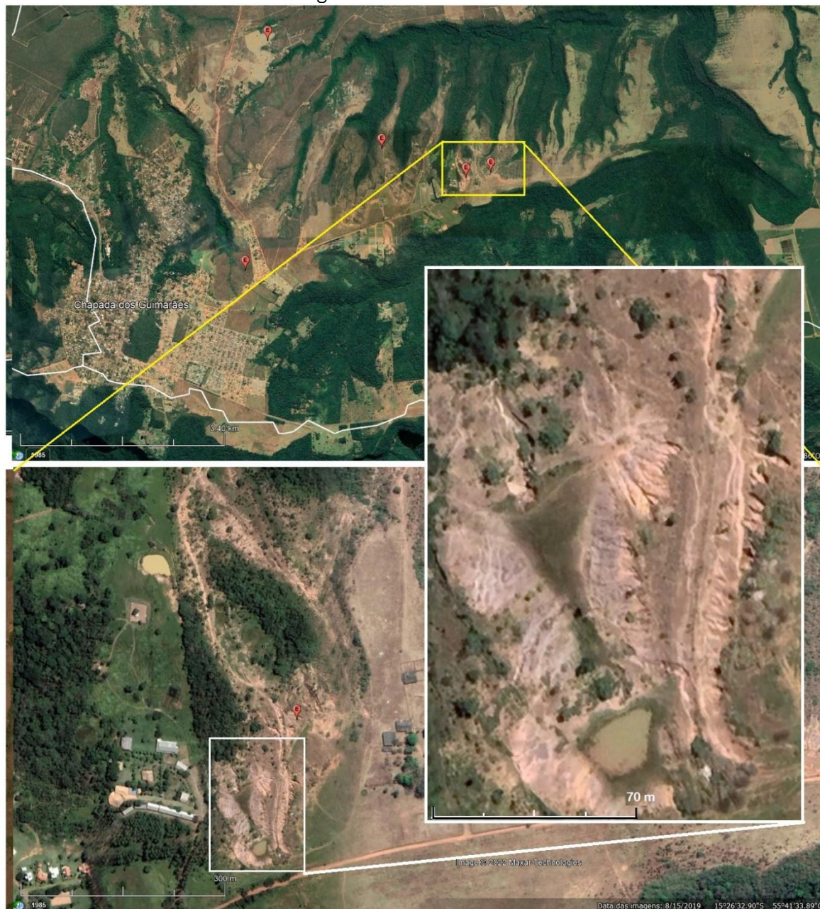
Figura 88. Erosões em cabeceira de drenagem na região a nordeste da cidade de Chapada dos Guimarães. Coordenadas de Lat. 15° 26'32.90"S e Long. 55°41'33.89"O. Imagem de 2019 obtida do Google Earth Pro em 05/10/2022.
