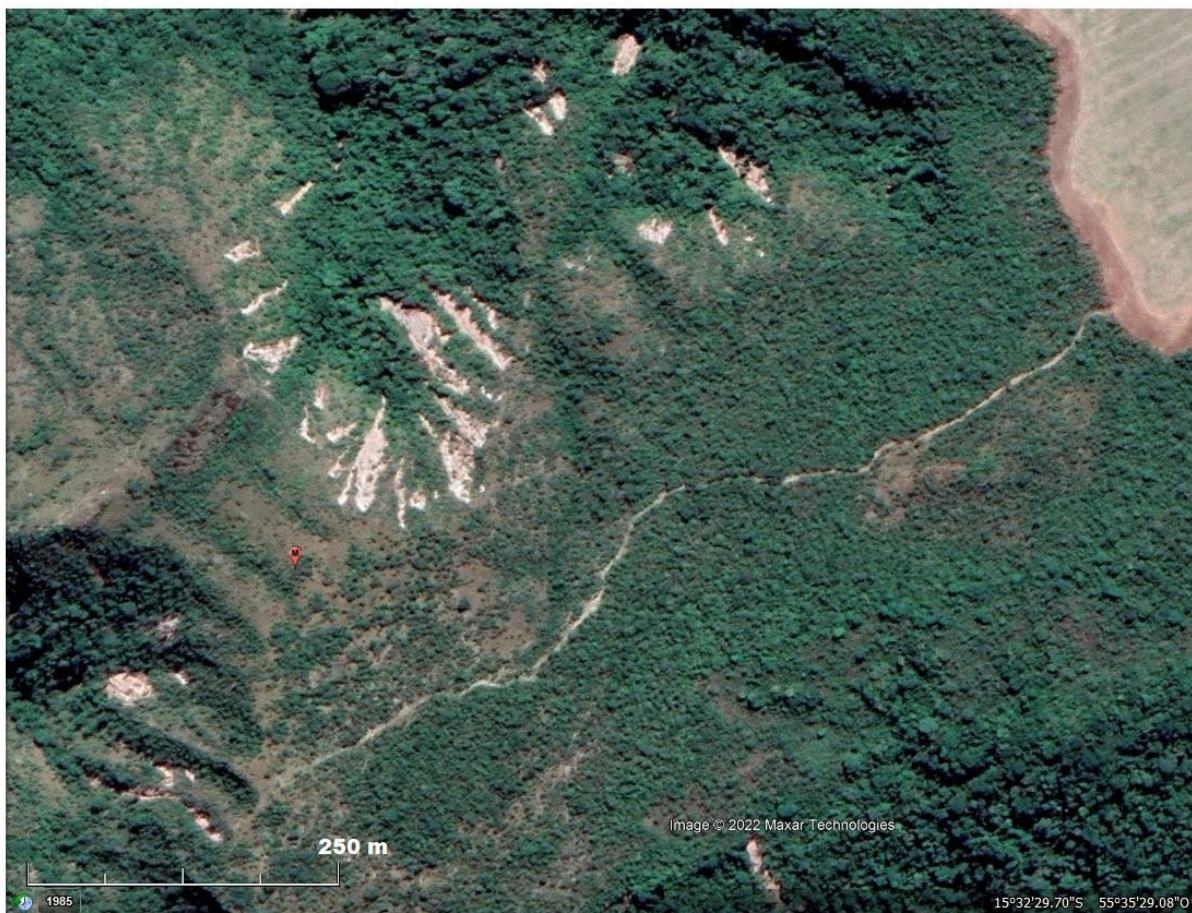
Figura 100. Múltiplos processos de movimentos de massa e erosão em terrenos de alta declividade. Coordenadas do local: Lat. 14° 44'12.30"S e Long. 56°18'57.11"O. Imagem de 2002 obtida do Google Earth Pro de 2022.
