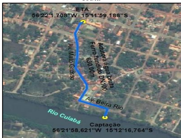
Figura 17. Caminhamento da adutora de água bruta
