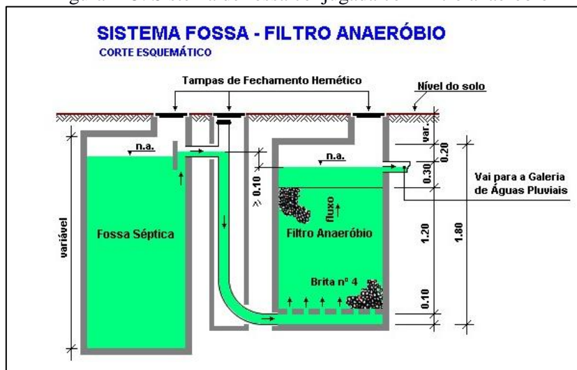
Figura 215. Sistema de fossa conjugada com filtro anaeróbio
