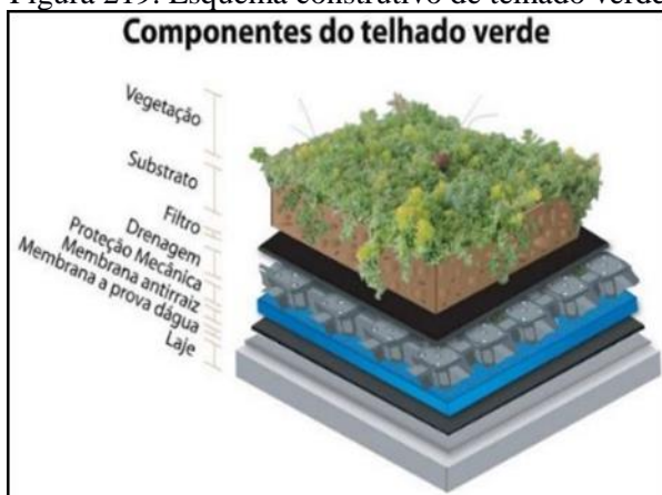
Figura 219. Esquema construtivo de telhado verde
