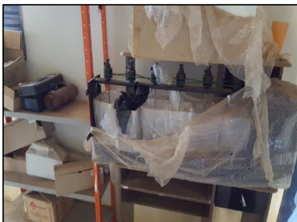
Figura 145. Jar-test e turbidímetro inoperante no laboratório da ETA de Baús
