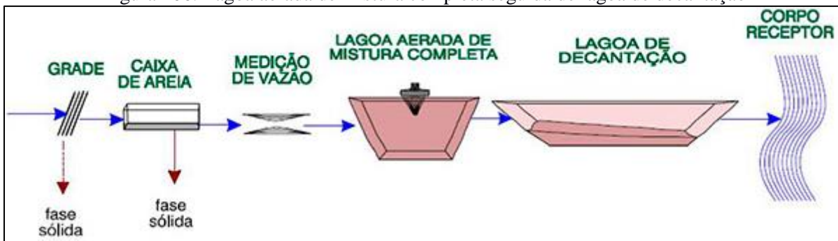
Figura 206. Lagoa aerada de mistura completa seguida de lagoa de decantação
