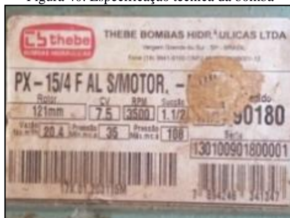
Figura 40. Especificação técnica da bomba
