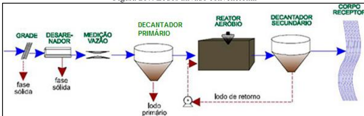
Figura 207. Lodos ativado convencional
