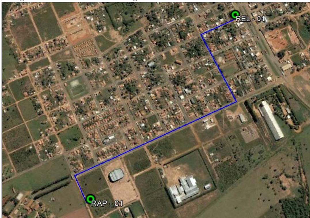
Figura 18. Percurso da adutora de água tratada do RAP-01 até o reservatório REL-01
