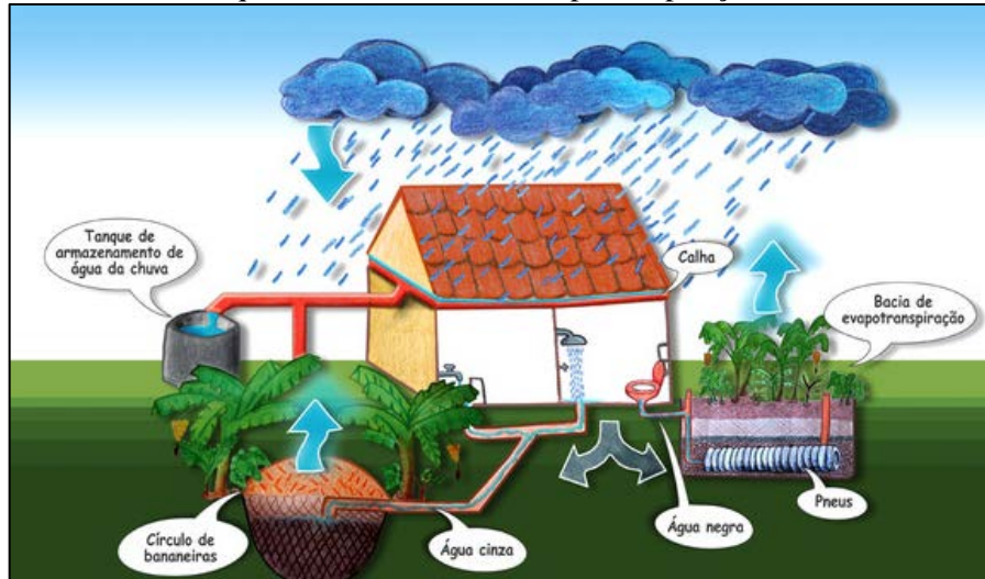
Figura 82. Desenho esquemático da bacia de evapotranspiração e círculo de bananeiras
