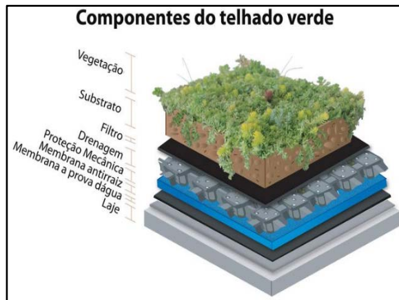
Figura 86. Esquema construtivo de telhado verde
