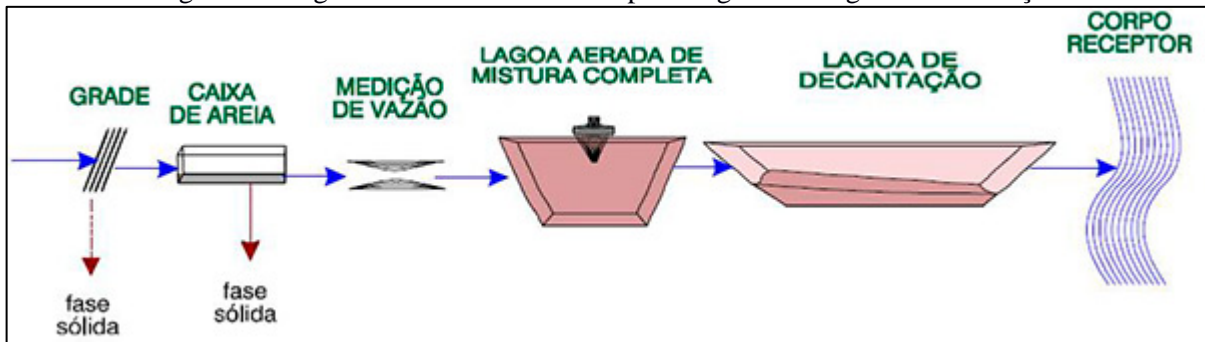
Figura 44. Lagoa aerada de mistura completa seguida de lagoa de decantação
