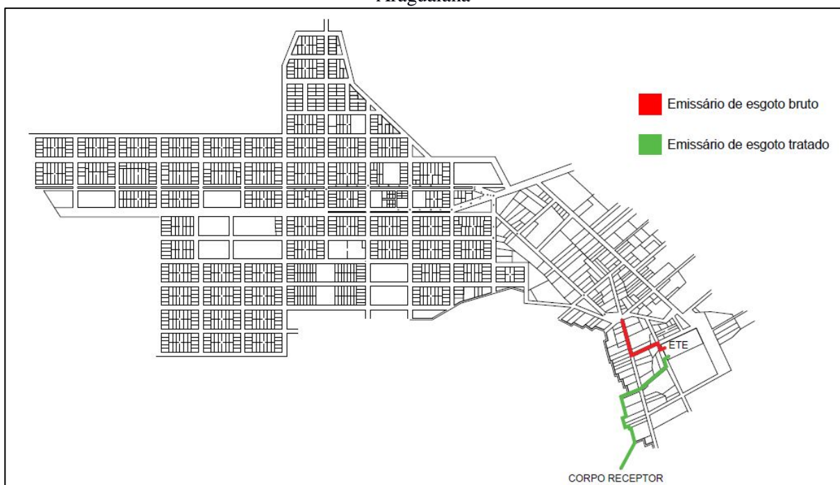
Figura 19. Caminhamento dos emissários de esgoto do sistema de esgotamento sanitário de Araguaiana
