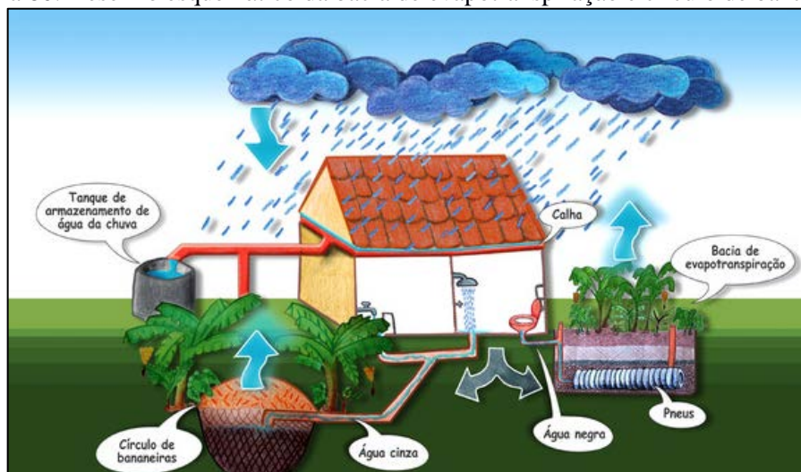
Figura 80. Desenho esquemático da bacia de evapotranspiração e círculo de bananeiras
