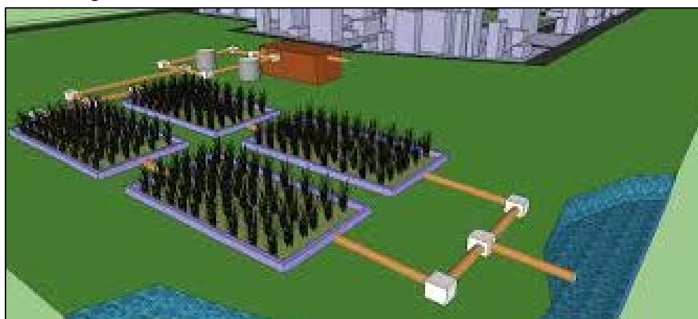
Figura 81. Sistema de tratamento individual utilizando zonas de raízes
