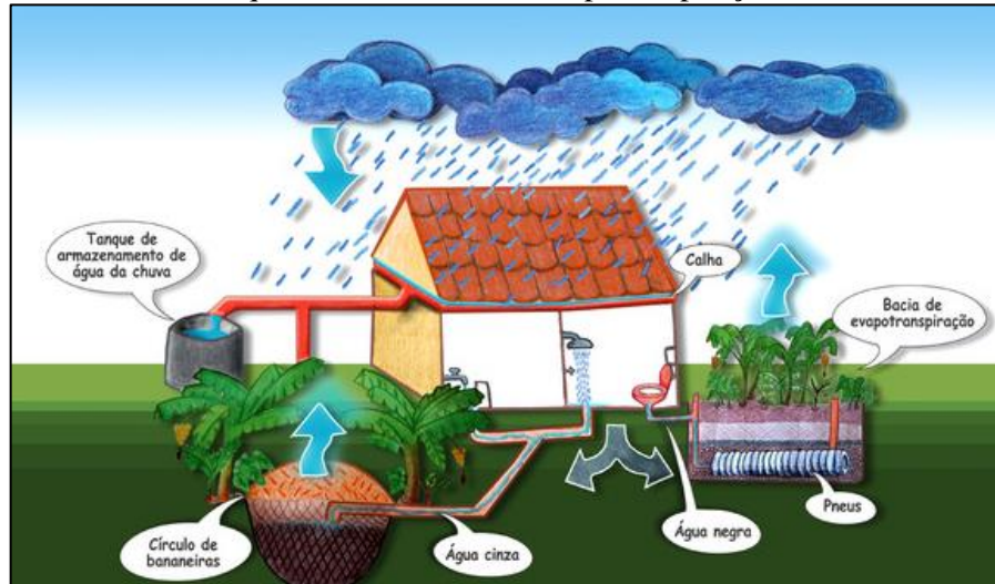
Figura 123. Desenho esquemático da bacia de evapotranspiração e círculo de bananeiras
