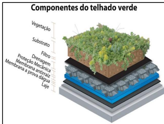
Figura 127. Esquema construtivo de telhado verde
