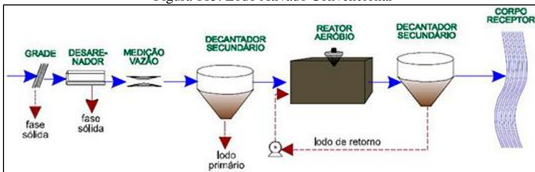
Figura 115. Lodo Ativado Convencional
