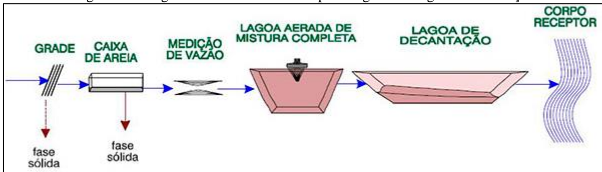
Figura 114. Lagoa aerada de mistura completa seguida de lagoa de decantação
