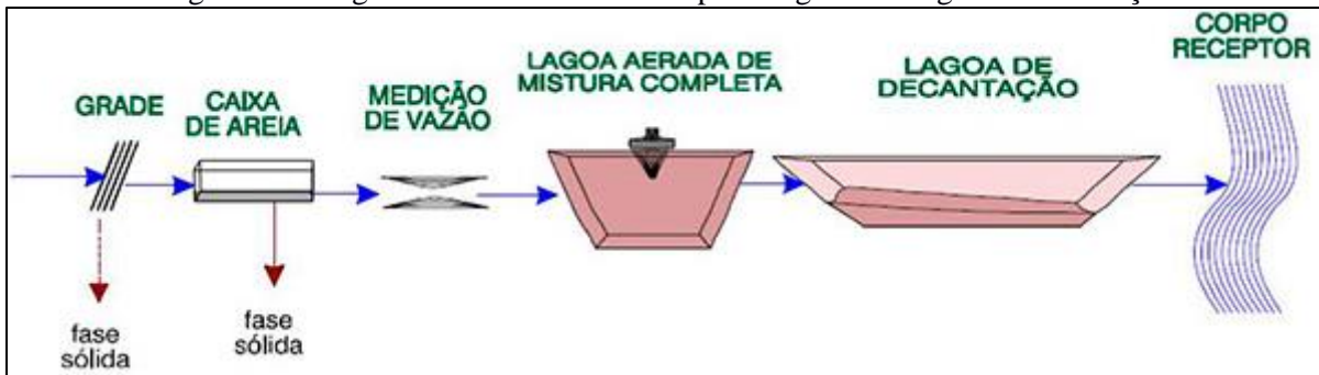
Figura 102. Lagoa aerada de mistura completa seguida de lagoa de decantação
