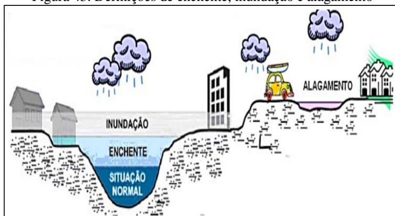
Figura 43. Definições de enchente, inundação e alagamento
