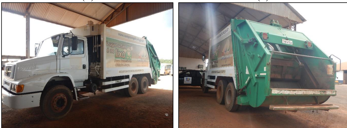
Figura 20. (A) Visão geral do caminhão (B) Compactador acoplado ao caminhão
