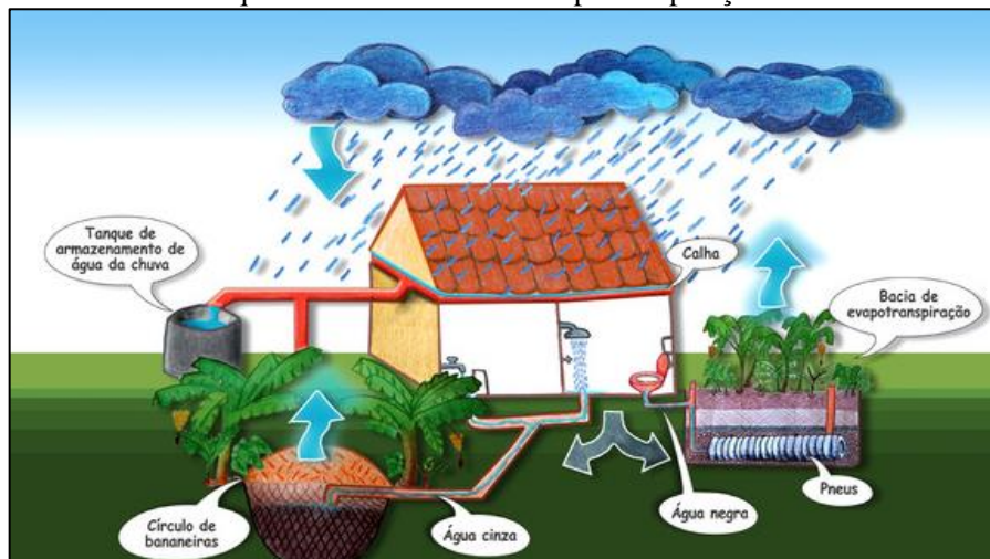
Figura 49. Desenho esquemático da bacia de evapotranspiração e círculo de bananeiras
