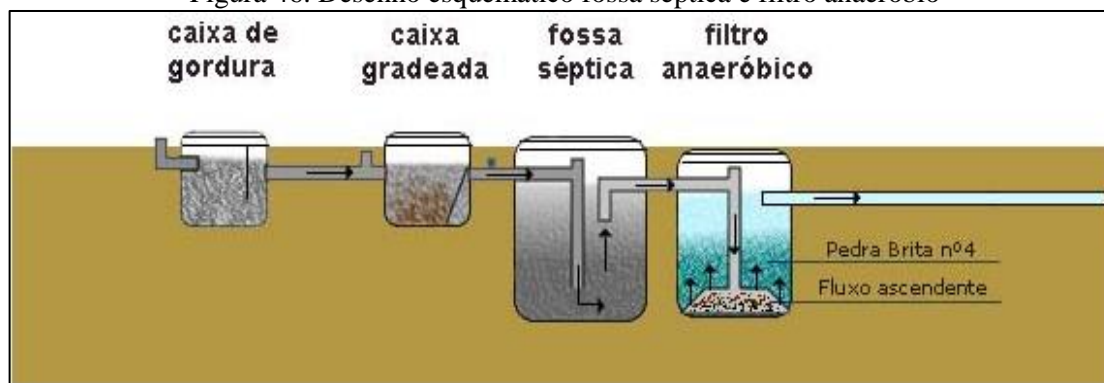
Figura 46. Desenho esquemático fossa séptica e filtro anaeróbico
