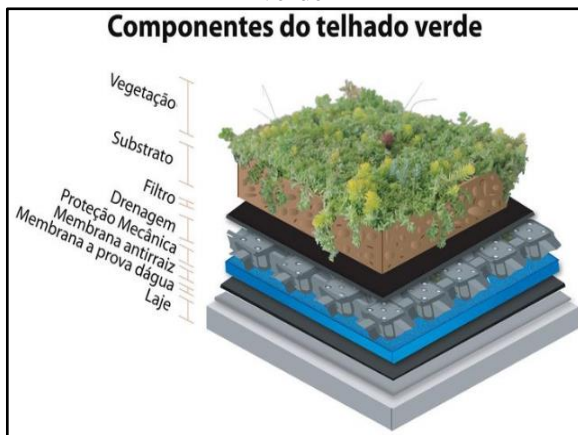
Figura 86. Esquema construtivo de telhado verde
