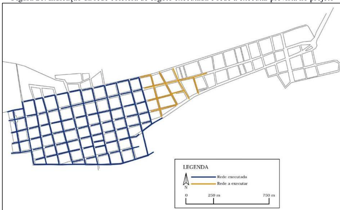
Figura 20. Indicação da rede coletora de esgoto executada e rede a executar prevista no projeto
