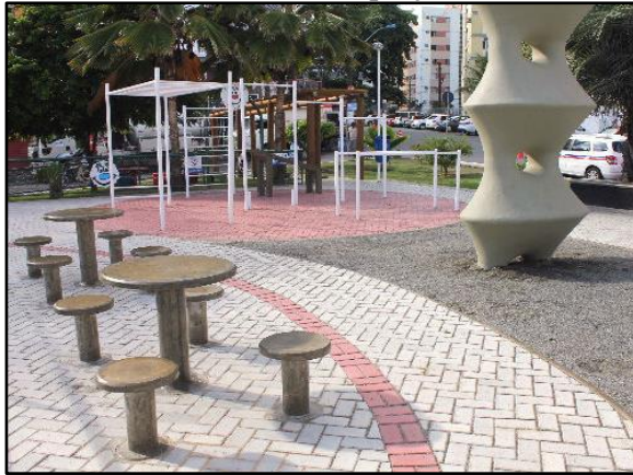
Figura 88. Pavimento poroso – piso intertravado instalado em praça
