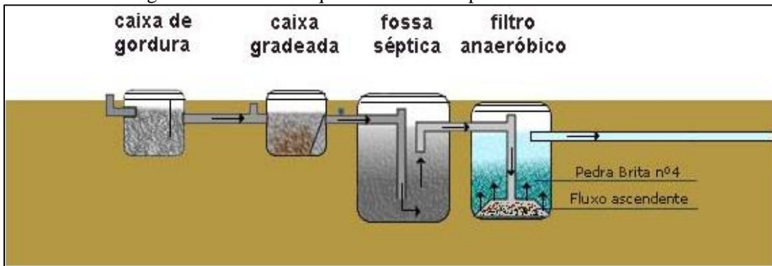
Figura 79. Desenho esquemático fossa séptica e filtro anaeróbio
