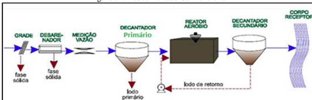
Figura 74. Lodos Ativado Convencional
