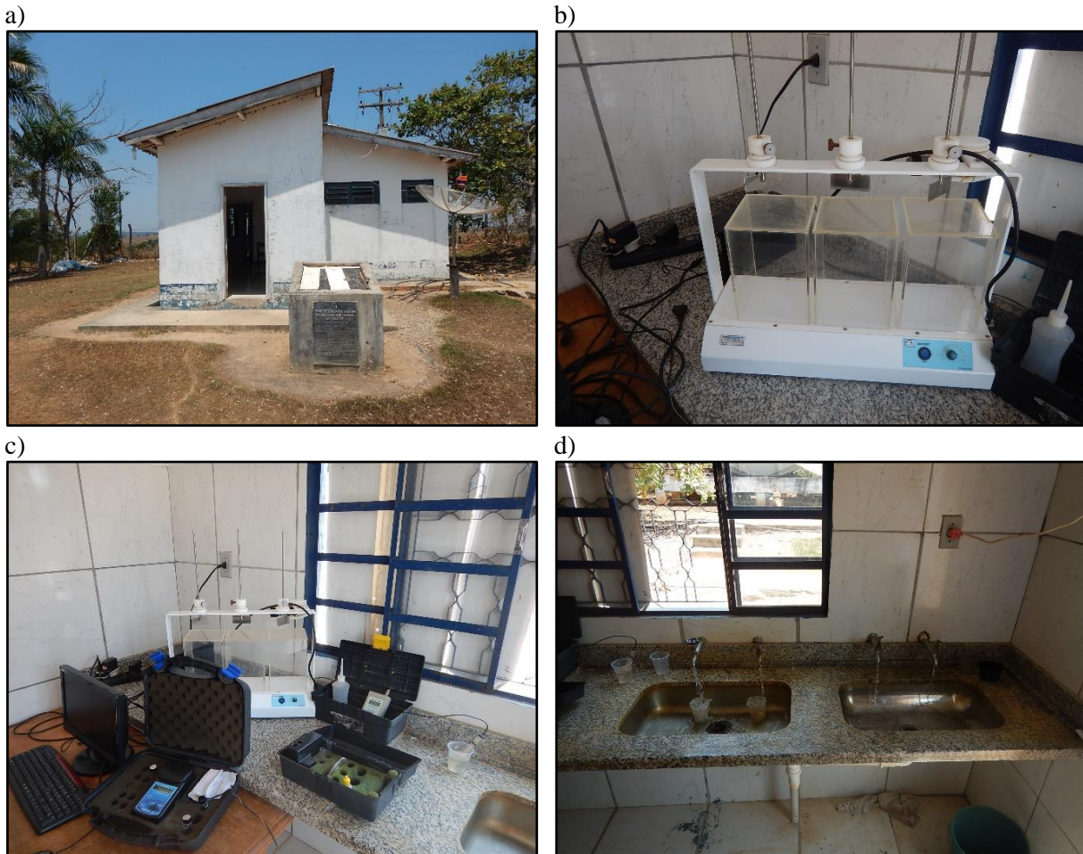
Figura 20. a) Estrutura da Casa de Química; b) Aparelho Jar test ; c) Aparelho turbidímetro e colorímetro d) Ponto de amostra de água bruta e tratada
