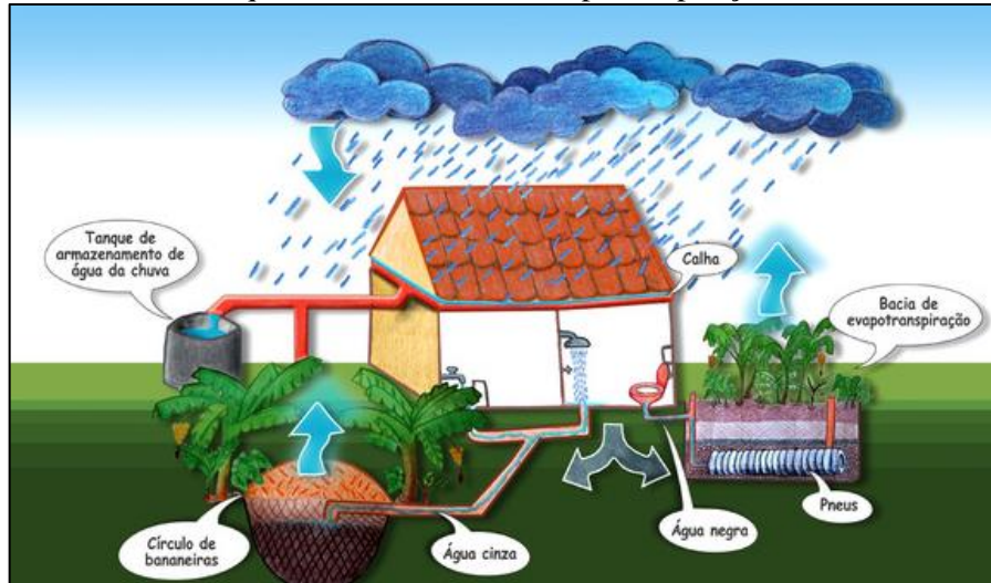
Figura 110. Desenho esquemático da bacia de evapotranspiração e círculo de bananeiras
