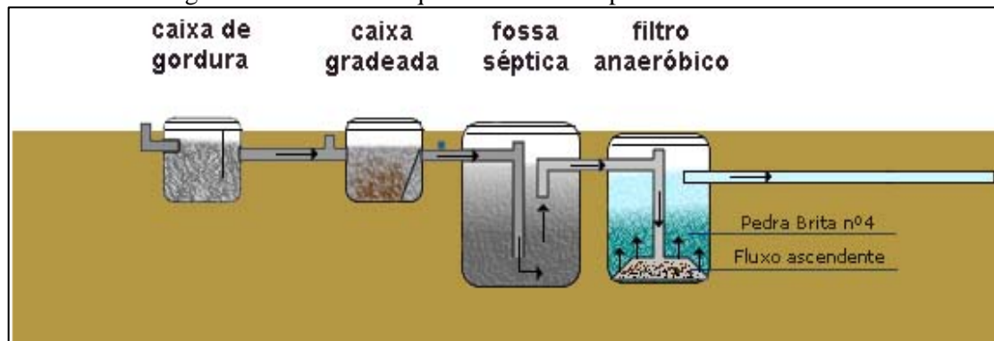
Figura 101. Desenho esquemático fossa séptica e filtro anaeróbio
