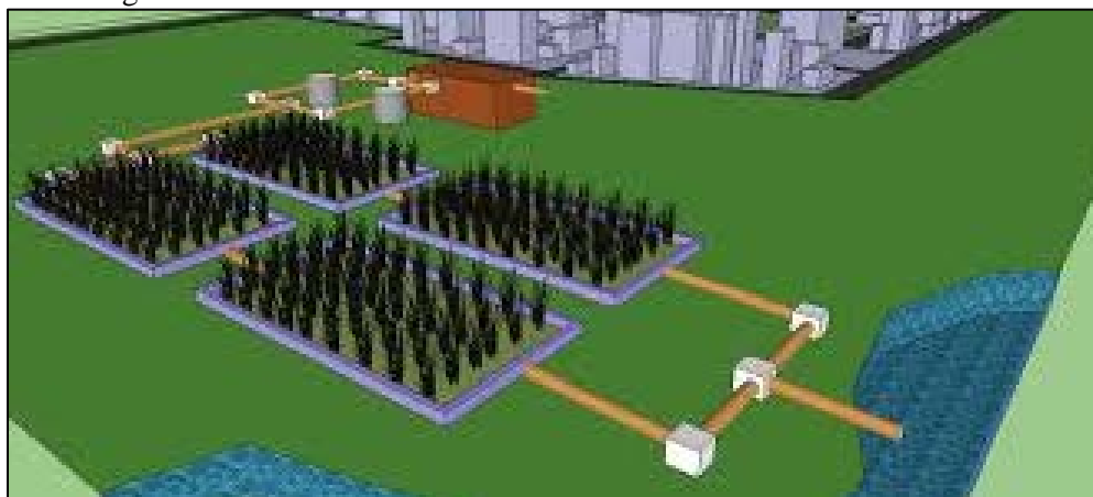
Figura 105. Sistema de tratamento individual utilizando zonas de raízes
