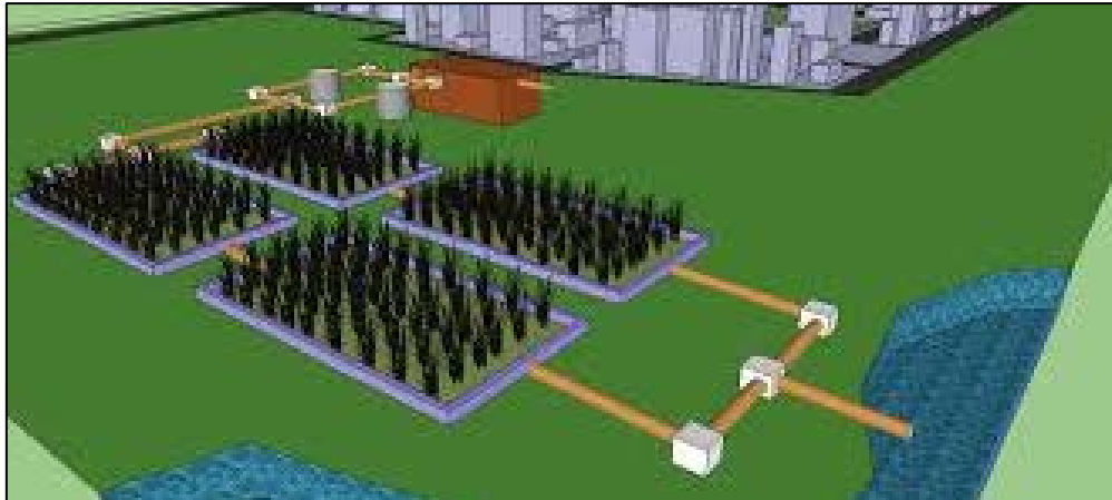
Figura 131. Sistema de tratamento individual utilizando zonas de raízes
