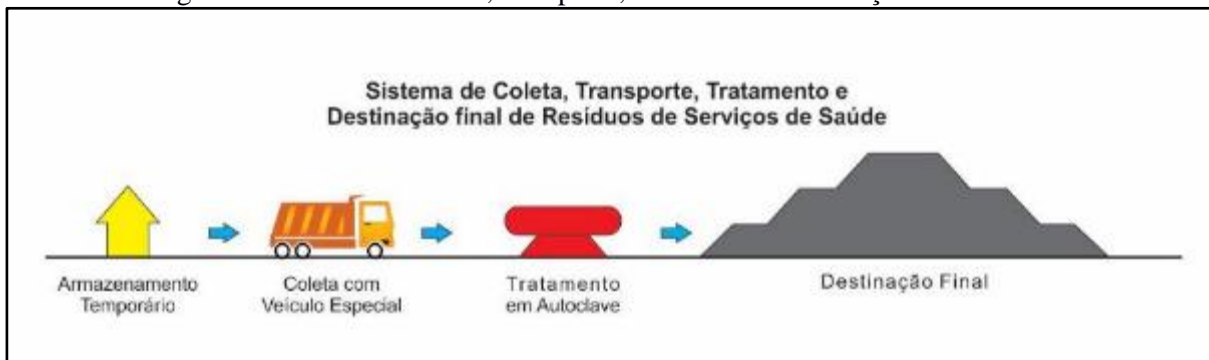
Figura 95. Sistema de coleta, transporte, tratamento e destinação final de RSS
