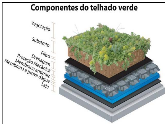
Figura 134. Esquema construtivo de telhado verde
