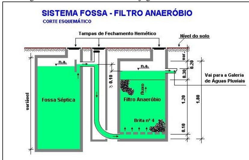
Figura 124. Sistema de fossa conjugada com filtro anaeróbio
