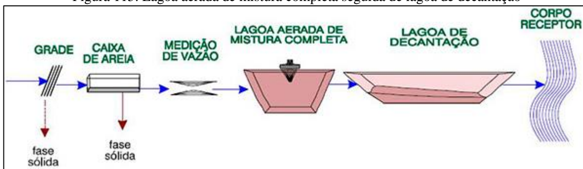
Figura 115. Lagoa aerada de mistura completa seguida de lagoa de decantação
