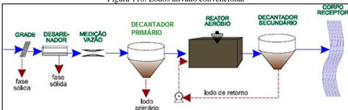
Figura 116. Lodos ativado convencional
