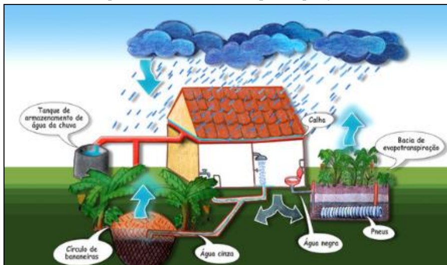
Figura 75. Desenho esquemático da bacia de evapotranspiração e círculo de bananeiras
