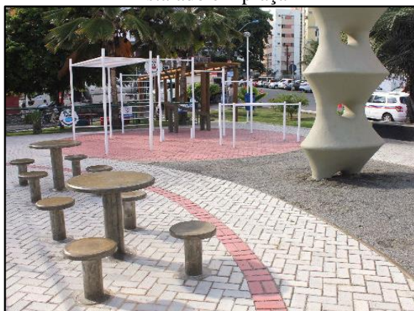
Figura 78. Pavimento poroso – piso intertravado instalado em praça
