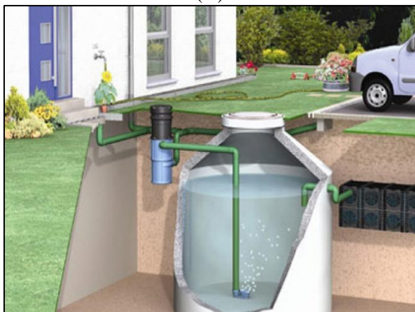
Figura 86. Tipos de reservatórios individuais para reaproveitamento de águas pluviais (A) Controle na fonte (B) Esquema de água pluvial na fonte
