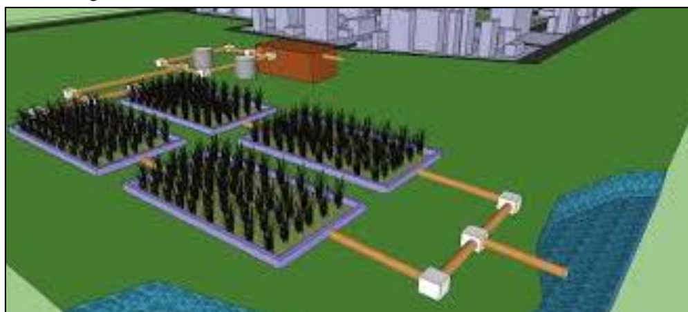
Figura 74. Sistema de tratamento individual utilizando zonas de raízes
