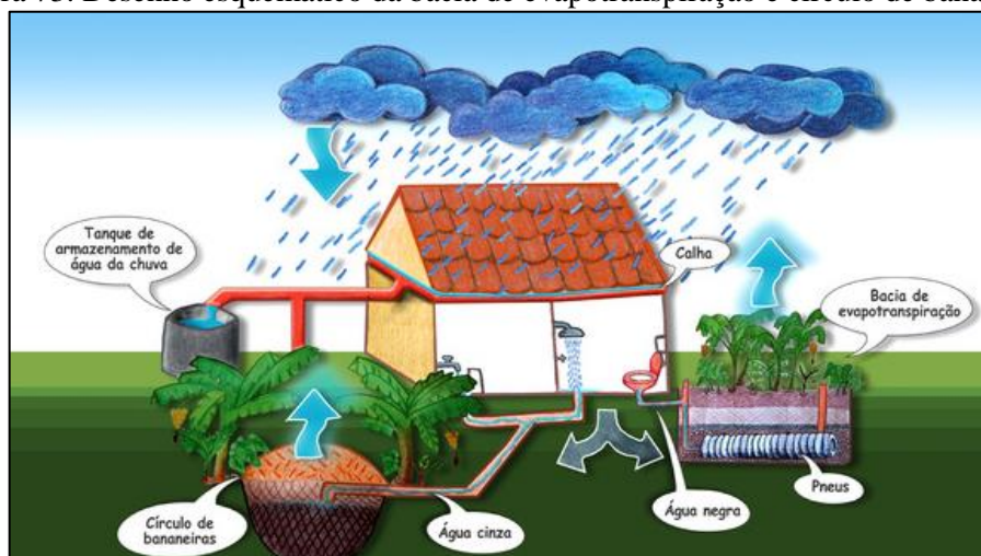
Figura 73. Desenho esquemático da bacia de evapotranspiração e círculo de bananeiras
