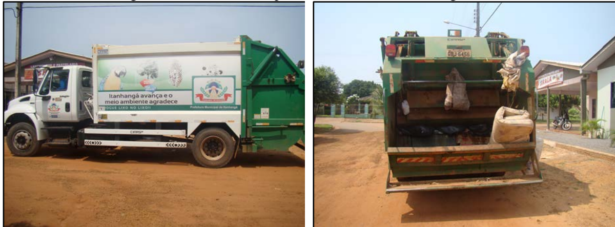
Figura 28. Caminhão compactador de 10 m 3 de Itanhangá-MT
