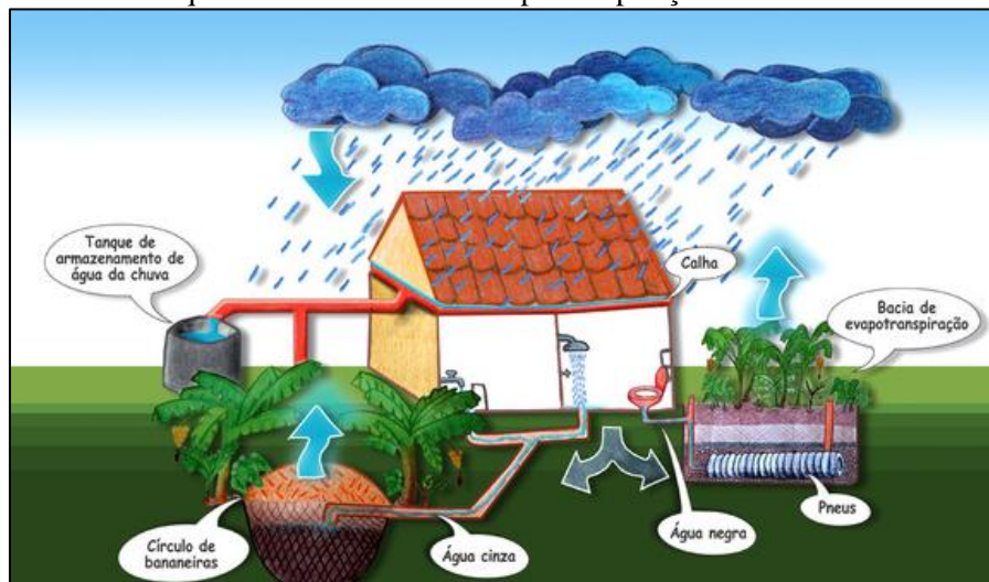
Figura 62. Desenho esquemático da bacia de evapotranspiração e círculo de bananeiras
