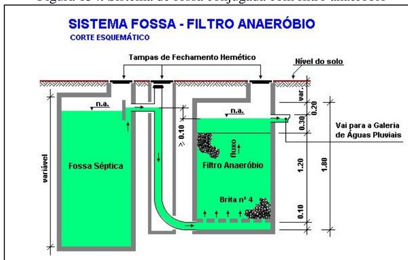
Figura 154. Sistema de fossa conjugada com filtro anaeróbio
