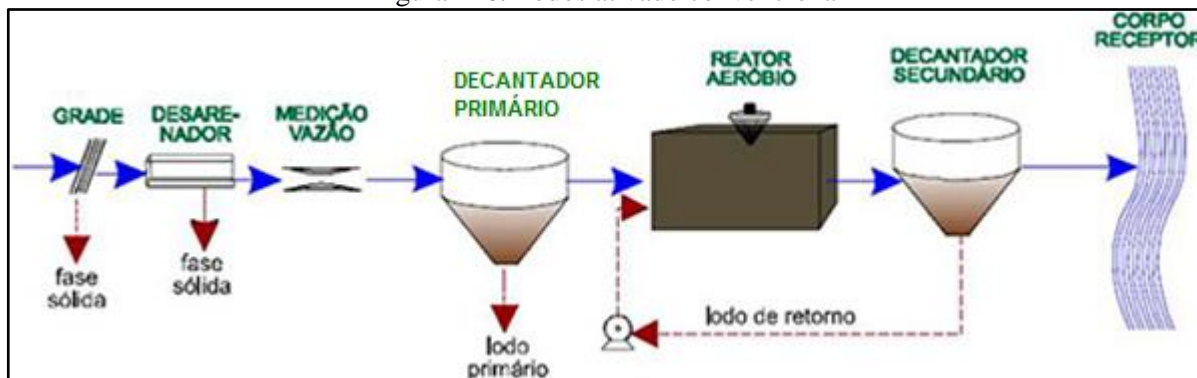
Figura 146. Lodos ativado convencional
