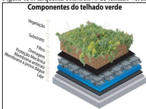
Figura 158. Esquema construtivo de telhado verde
