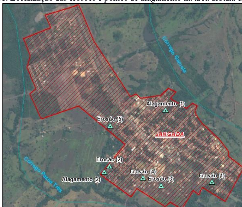
Figura 61. Localização das erosões e pontos de alagamento na área urbana de Jangada
