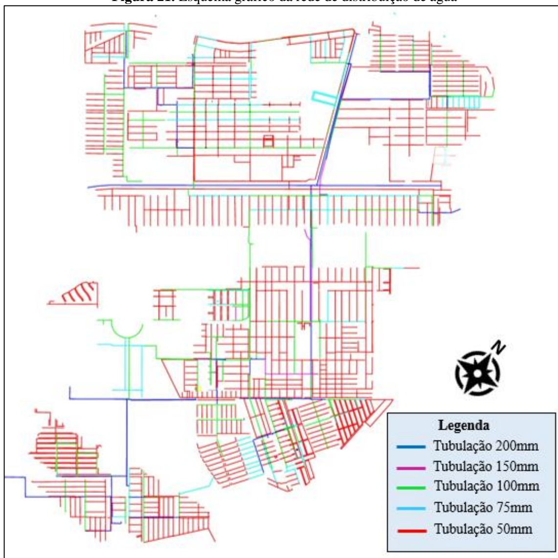
Figura 21. Esquema gráfico da rede de distribuição de água
