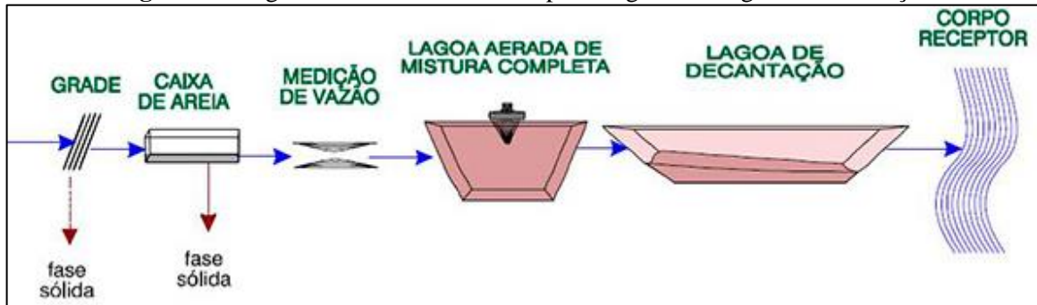
Figura 99. Lagoa aerada de mistura completa seguida de lagoa de decantação
