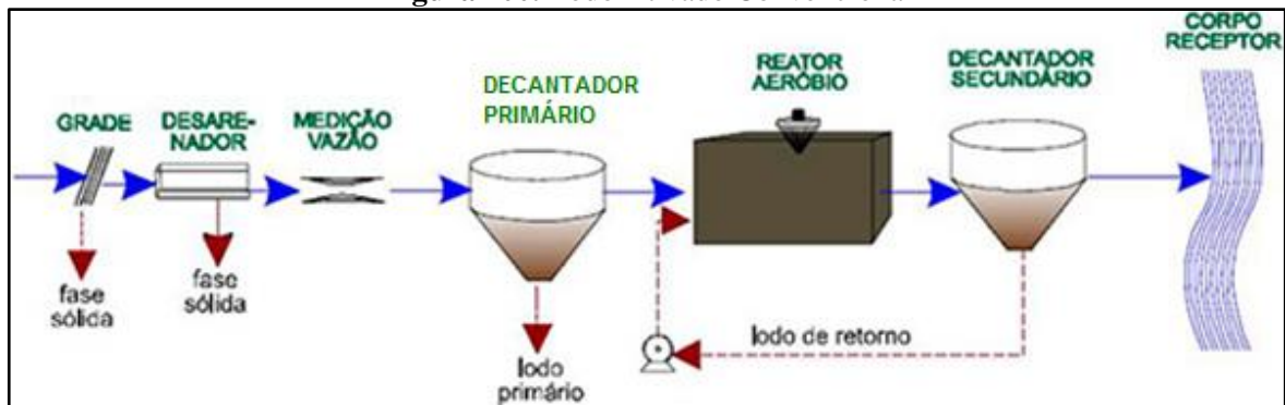
Figura 100. Lodo Ativado Convencional
