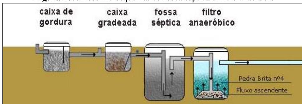
Figura 105. Desenho esquemático fossa séptica e filtro anaeróbio
