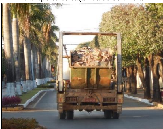
Figura 68. Caminhão poliguindaste de empresa privada utilizado para transporte de caçamba de bota-fora
