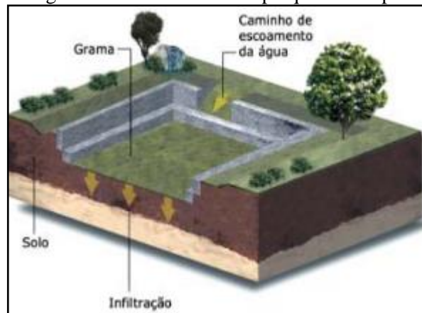
Figura 97. Reservatório em parque municipal
