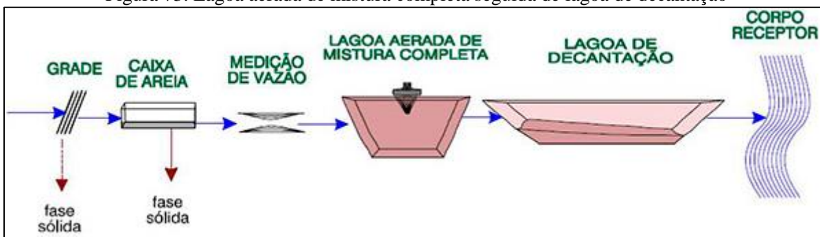
Figura 73. Lagoa aerada de mistura completa seguida de lagoa de decantação
