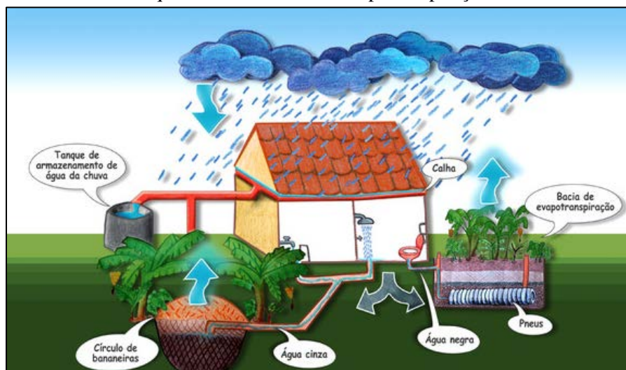
Figura 147. Desenho esquemático da bacia de evapotranspiração e círculo de bananeiras
