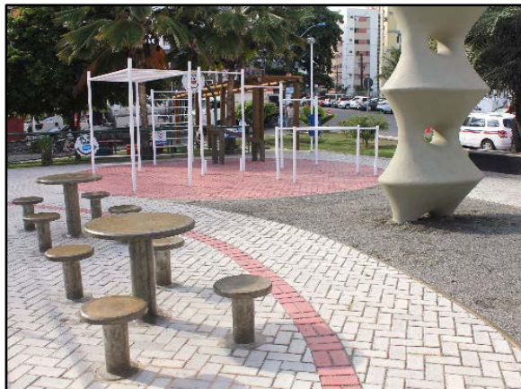
Figura 153. Pavimento poroso – piso intertravado instalado em praça
