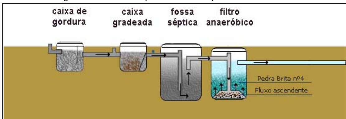
Figura 144. Desenho esquemático fossa séptica e filtro anaeróbio
