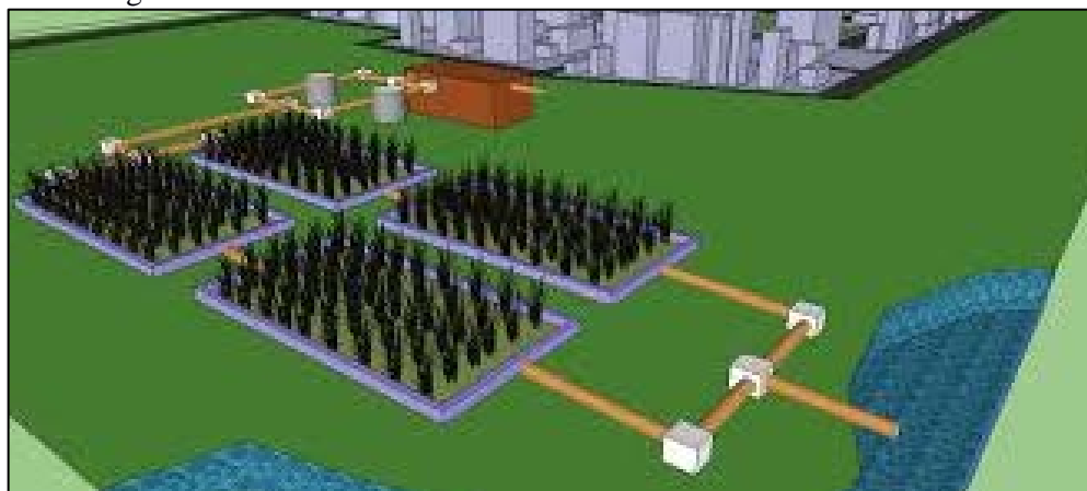
Figura 65. Sistema de tratamento individual utilizando zonas de raízes
