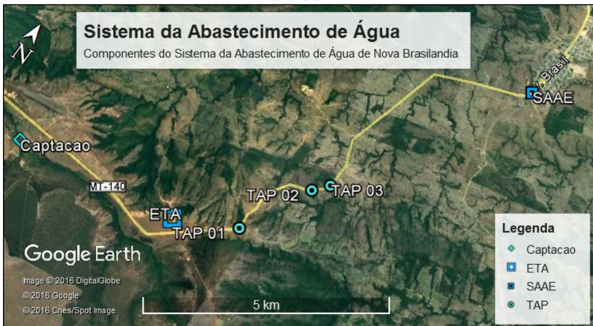
Figura 9. Localização dos principais componentes do Sistema de Abastecimento de Água de Nova Brasilândia-MT
