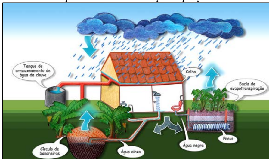
Figura 64. Desenho esquemático da bacia de evapotranspiração e círculo de bananeiras
