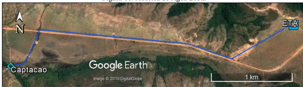
Figura 16. Adutora de Água Bruta
