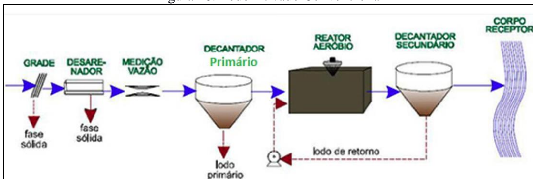
Figura 48. Lodo Ativado Convencional
