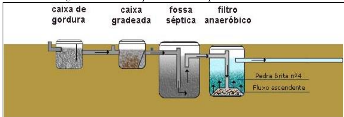
Figura 53. Desenho esquemático fossa séptica e filtro anaeróbio
