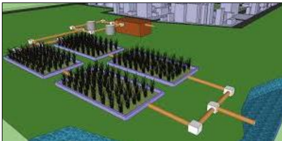
Figura 69. Sistema de tratamento individual utilizando zonas de raízes
