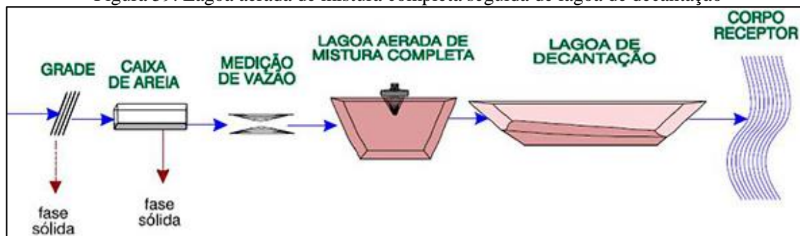
Figura 59. Lagoa aerada de mistura completa seguida de lagoa de decantação
