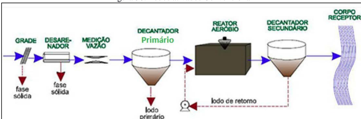
Figura 58. Lodos ativados Convencional
