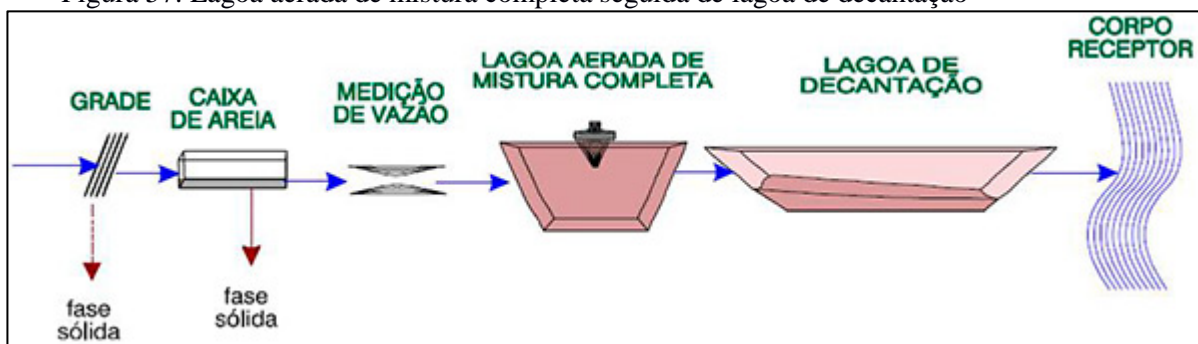
Figura 57. Lagoa aerada de mistura completa seguida de lagoa de decantação
