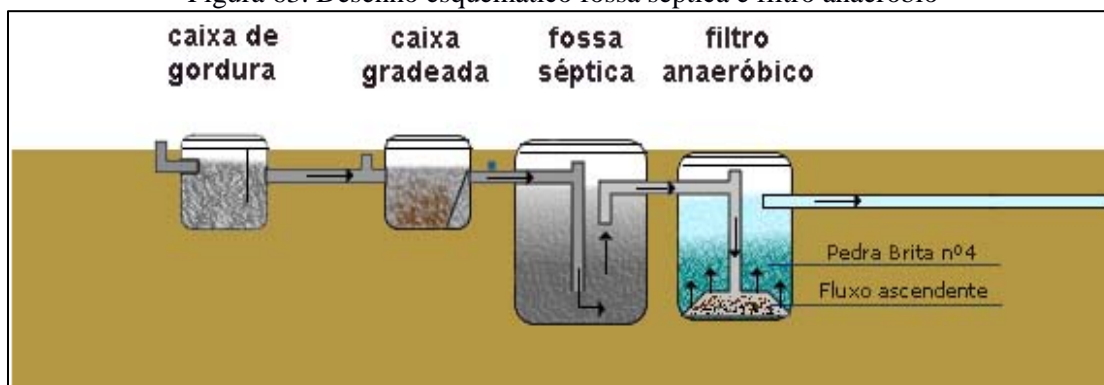
Figura 63. Desenho esquemático fossa séptica e filtro anaeróbio
