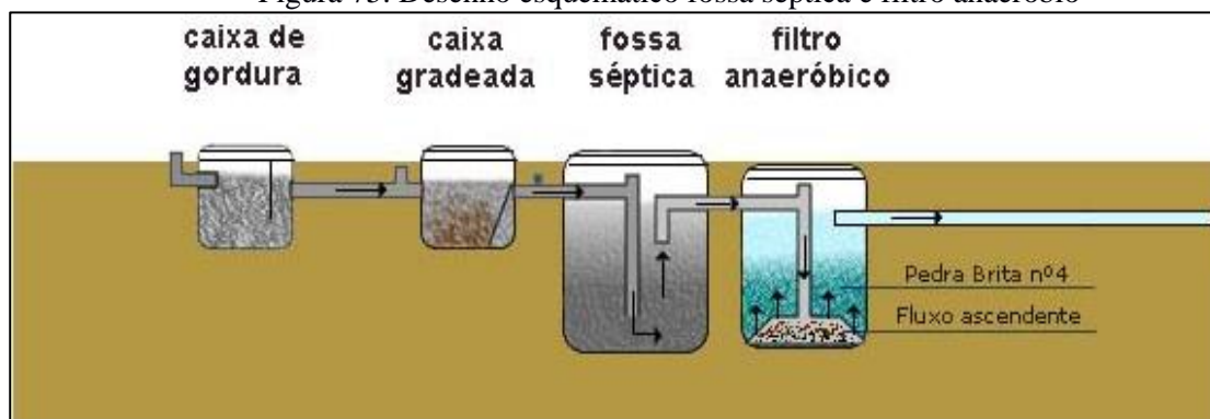
Figura 75. Desenho esquemático fossa séptica e filtro anaeróbio
