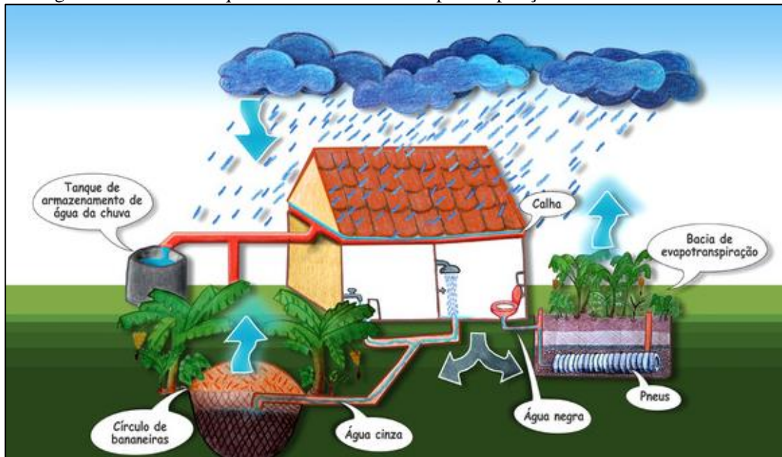
Figura 78. Desenho esquemático da bacia de evapotranspiração e círculo de bananeiras
