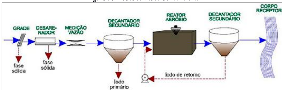
Figura 70. Lodos ativados Convencional
