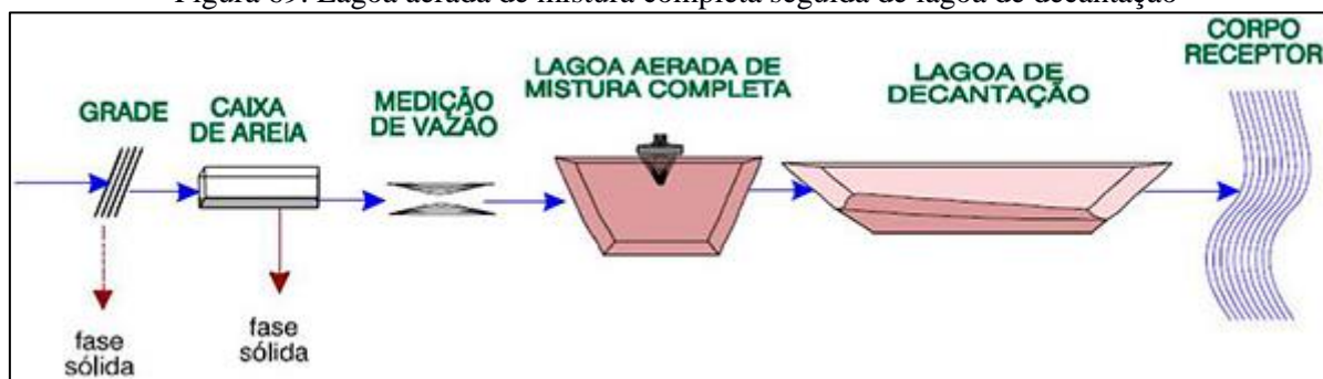
Figura 69. Lagoa aerada de mistura completa seguida de lagoa de decantação
