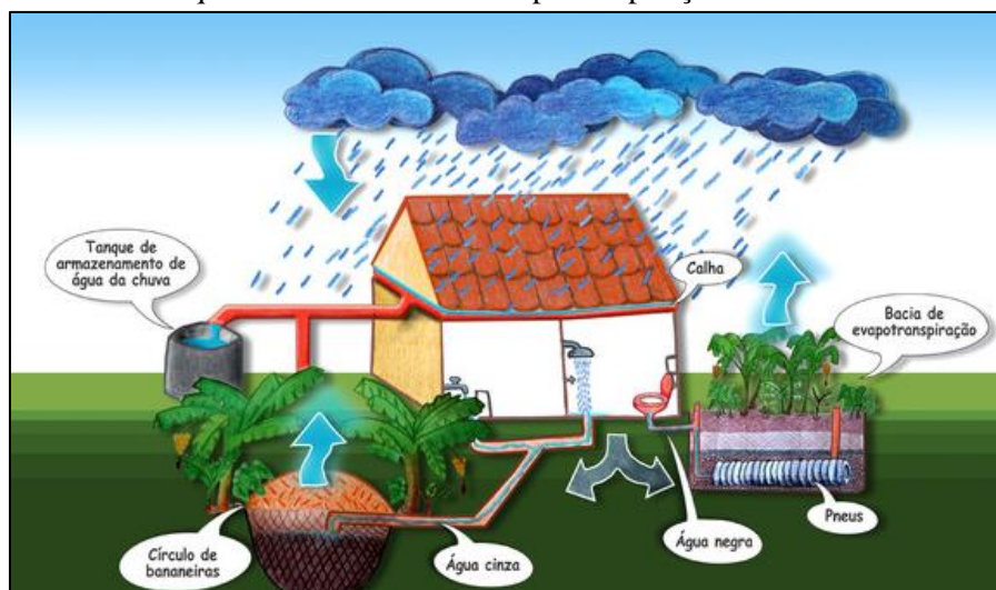
Figura 122. Desenho esquemático da bacia de evapotranspiração e círculo de bananeiras
