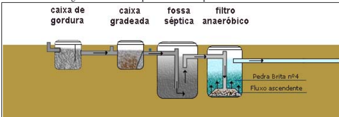
Figura 98. Desenho esquemático fossa séptica e filtro anaeróbio
