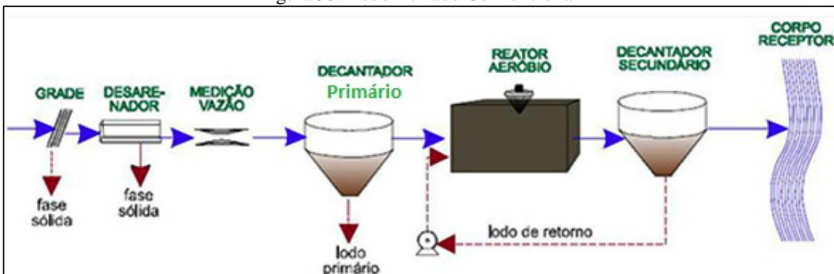
Figura 93. Lodo Ativado Convencional
