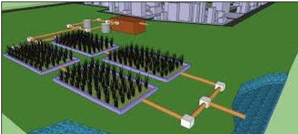
Figura 102. Sistema de tratamento individual utilizando zonas de raízes
