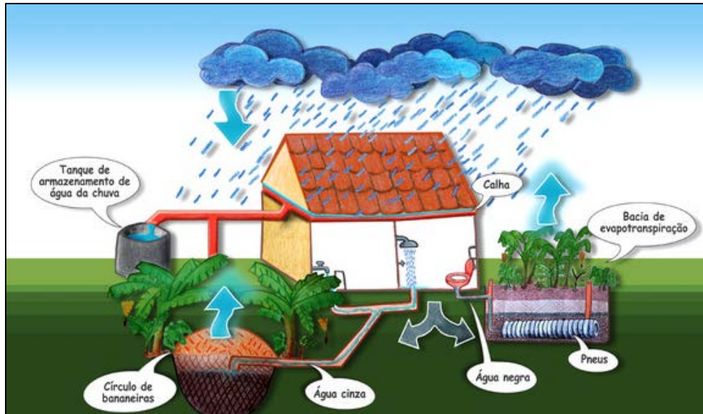
Figura 101. Desenho esquemático da bacia de evapotranspiração e círculo de bananeiras
