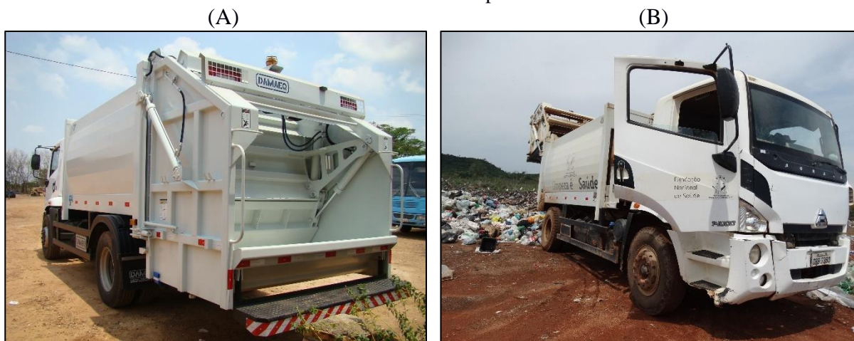
Figura 37. (A) Caminhão compactador para a coleta de RSDC em Peixoto de Azevedo (B) Despejo no lixão do município
