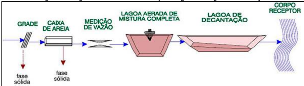
Figura 71. Lagoa aerada de mistura completa seguida de lagoa de decantação
