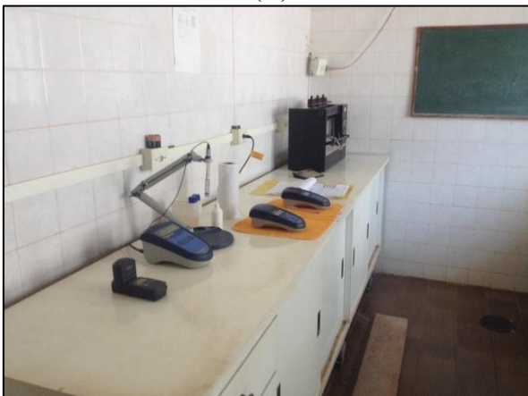
Figura 23. Laboratório ETA Peixoto de Azevedo: (A) Aparelhos de análise da água (B) Saída da água para coleta de amostras, efluente filtrado, decantado e bruto, respectivamente
