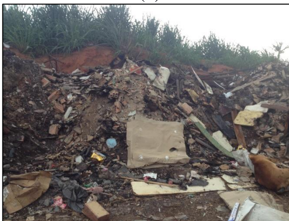
Figura 45. (A) Resíduos de construção e demolição dispostos no lixão municipal (B) Resíduos de alvenarias e solo misturados com outros resíduos
