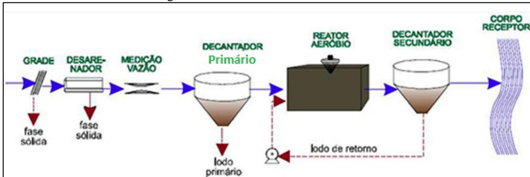
Figura 72. Lodo Ativado Convencional
