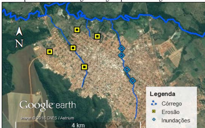
Figura 44. Locais com problemas de drenagem de águas pluviais na região urbana de Pontes e Lacerda
