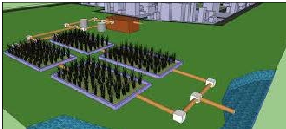
Figura 104. Sistema de tratamento individual utilizando zonas de raízes
