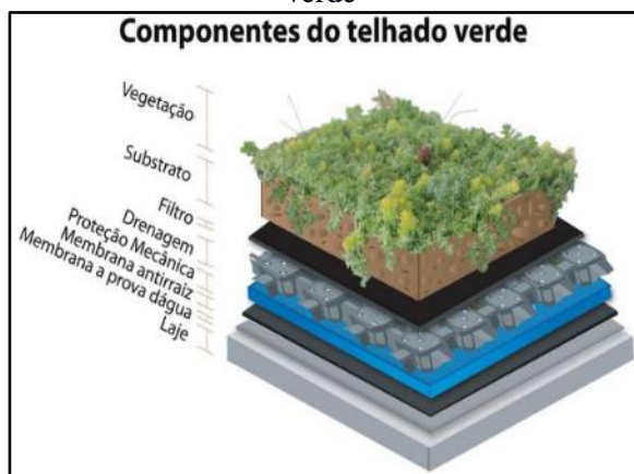
Figura 107. Esquema construtivo de telhado verde
