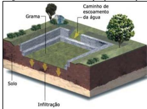
Figura 130. Reservatório em parque municipal
