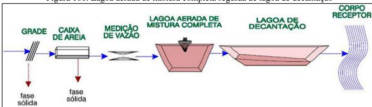
Figura 106. Lagoa aerada de mistura completa seguida de lagoa de decantação
