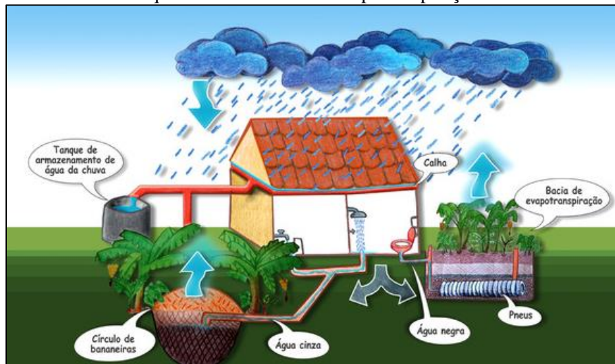
Figura 115. Desenho esquemático da bacia de evapotranspiração e círculo de bananeiras
