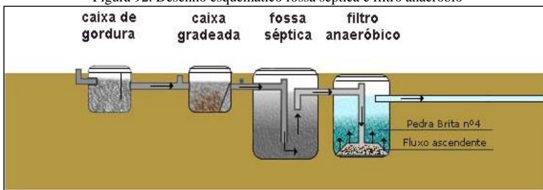
Figura 92. Desenho esquemático fossa séptica e filtro anaeróbio
