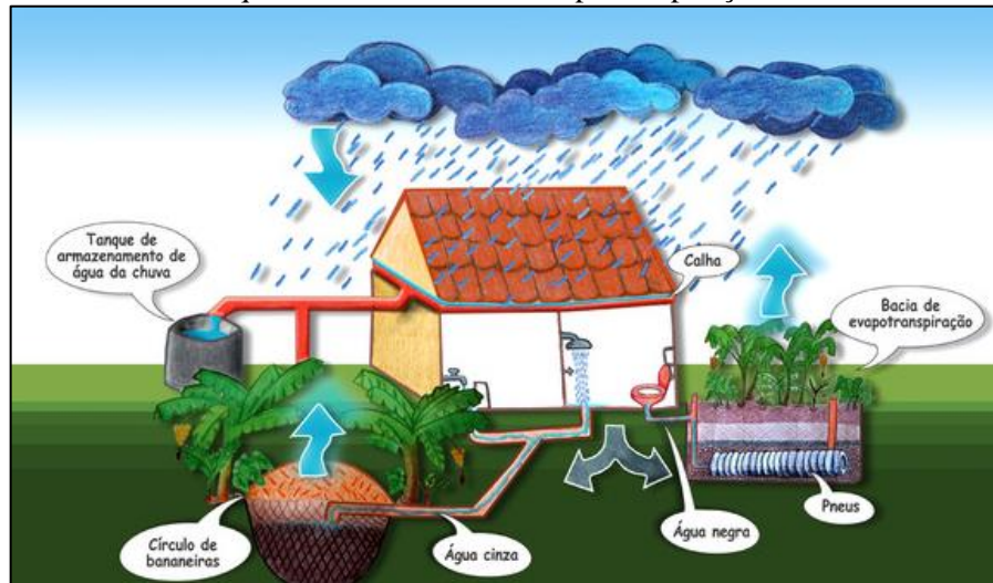
Figura 95. Desenho esquemático da bacia de evapotranspiração e círculo de bananeiras
