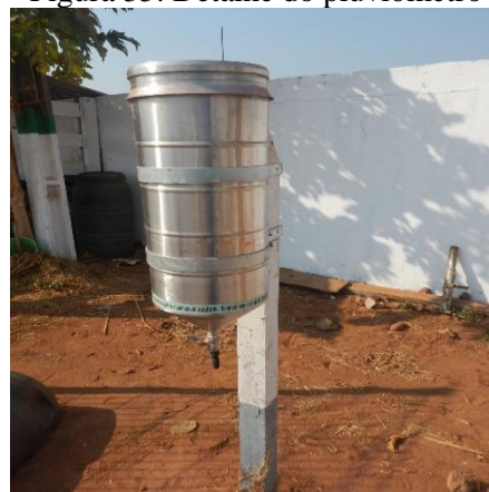
Figura 35. Detalhe do pluviômetro
