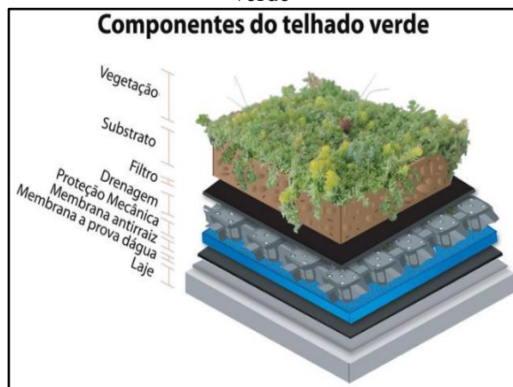
Figura 99. Esquema construtivo de telhado verde
