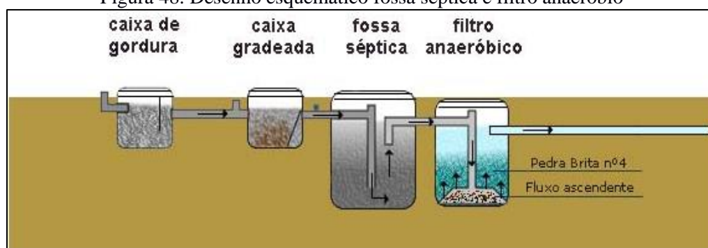
Figura 48. Desenho esquemático fossa séptica e filtro anaeróbio
