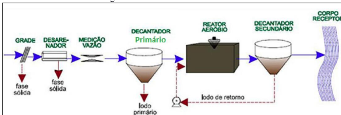
Figura 43. Lodo Ativado Convencional
