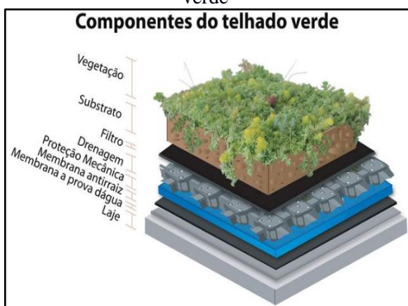
Figura 55. Esquema construtivo de telhado verde
