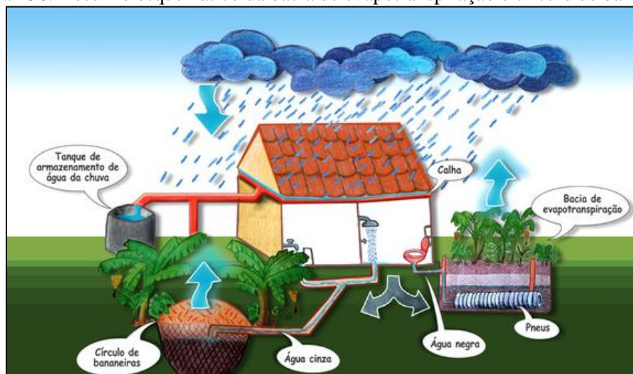
Figura 156. Desenho esquemático da bacia de evapotranspiração e círculo de bananeiras
