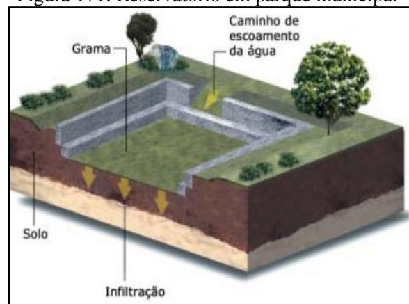
Figura 171. Reservatório em parque municipal
