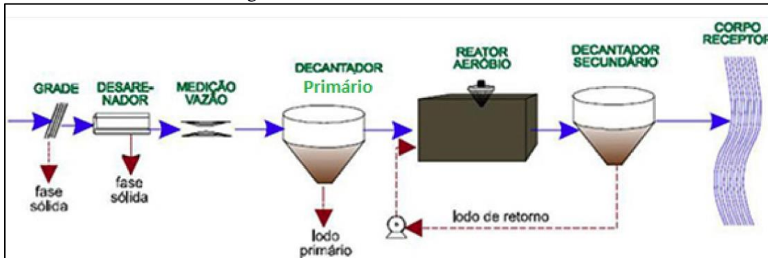
Figura 81. Lodo Ativado Convencional
