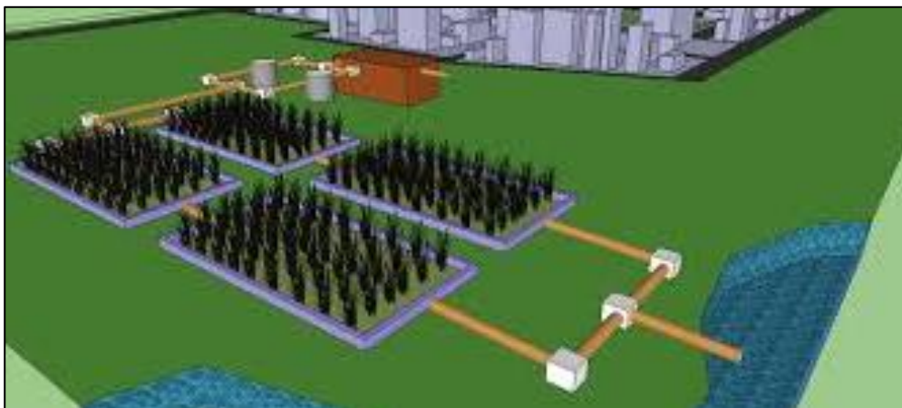
Figura 90. Sistema de tratamento individual utilizando zonas de raízes
