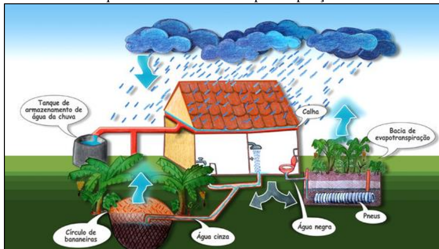
Figura 89. Desenho esquemático da bacia de evapotranspiração e círculo de bananeiras
