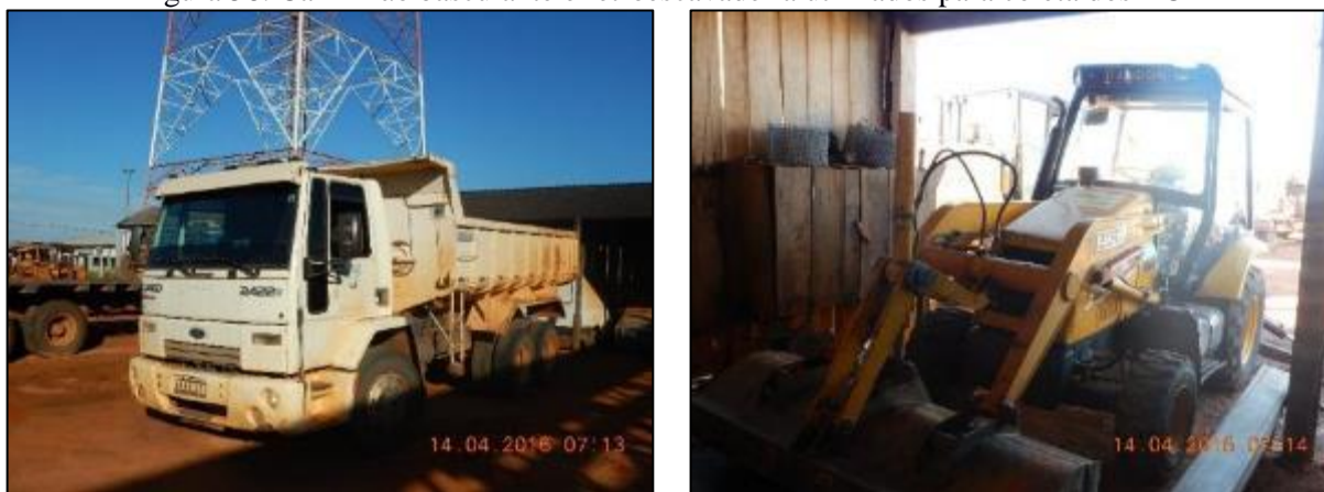
Figura 58. Caminhão basculante e retroescavadeira utilizados para coleta dos RCD
