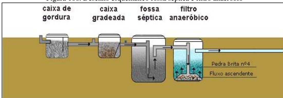
Figura 106. Desenho esquemático fossa séptica e filtro anaeróbico
