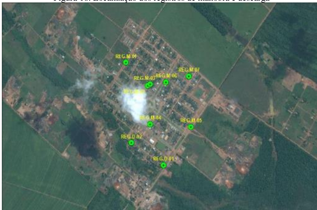
Figura 18. Localização dos registros de manobra e descarga
