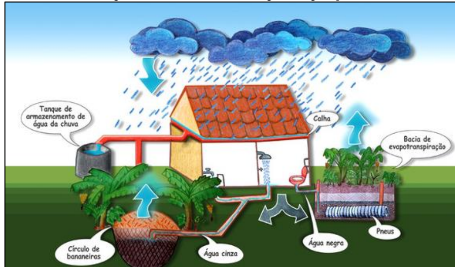
Figura 109. Desenho esquemático da bacia de evapotranspiração e círculo de bananeiras
