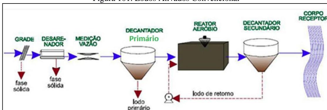
Figura 101. Lodos Ativados Convencional
