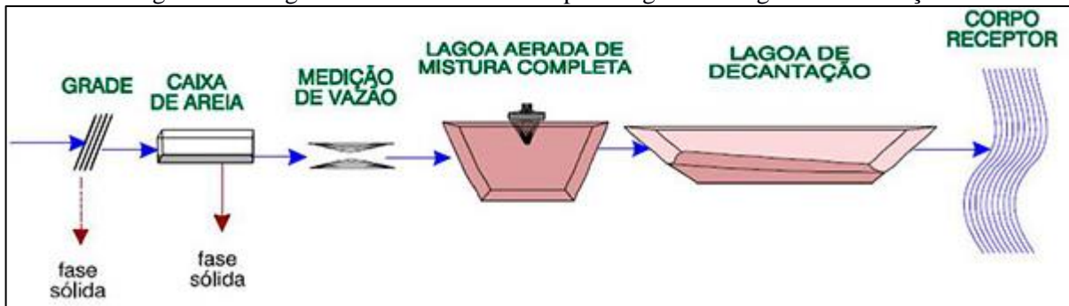
Figura 100. Lagoa aerada de mistura completa seguida de lagoa de decantação
