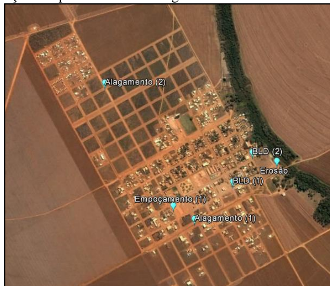
Figura 39. Localização dos problemas de drenagem na área urbana de Santo Antônio do Leste
