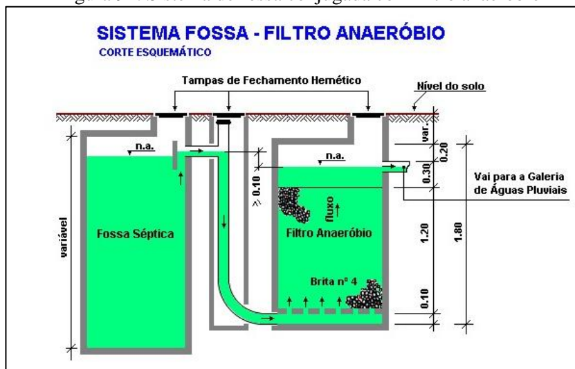
Figura 91. Sistema de fossa conjugada com filtro anaeróbio
