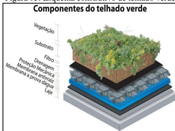
Figura 95. Esquema construtivo de telhado verde
