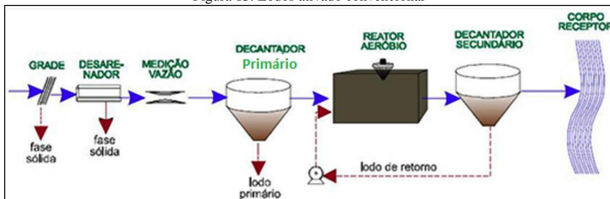
Figura 83. Lodos ativado convencional
