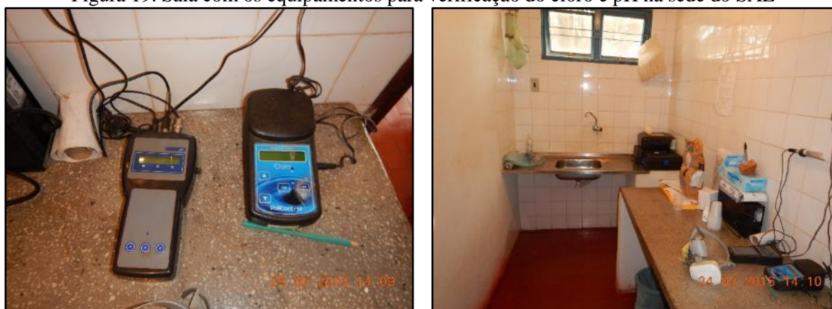
Figura 19. Sala com os equipamentos para verificação do cloro e pH na sede do SAE
