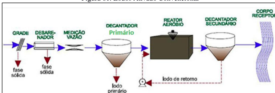
Figura 61. Lodos Ativado Convencional
