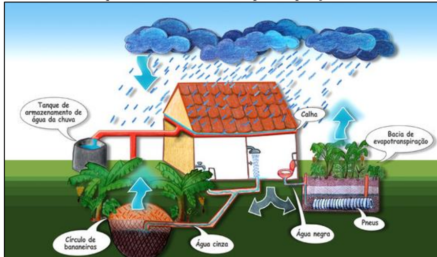
Figura 69. Desenho esquemático da bacia de evapotranspiração e círculo de bananeiras
