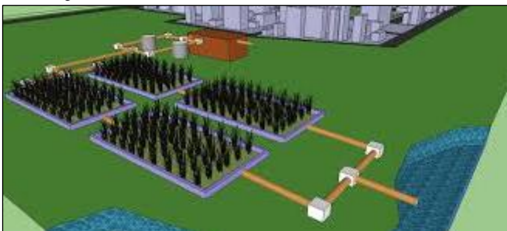
Figura 71. Sistema de tratamento individual utilizando zonas de raízes
