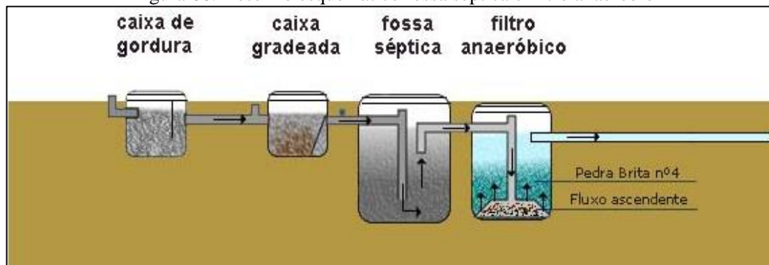
Figura 66. Desenho esquemático fossa séptica e filtro anaeróbico
