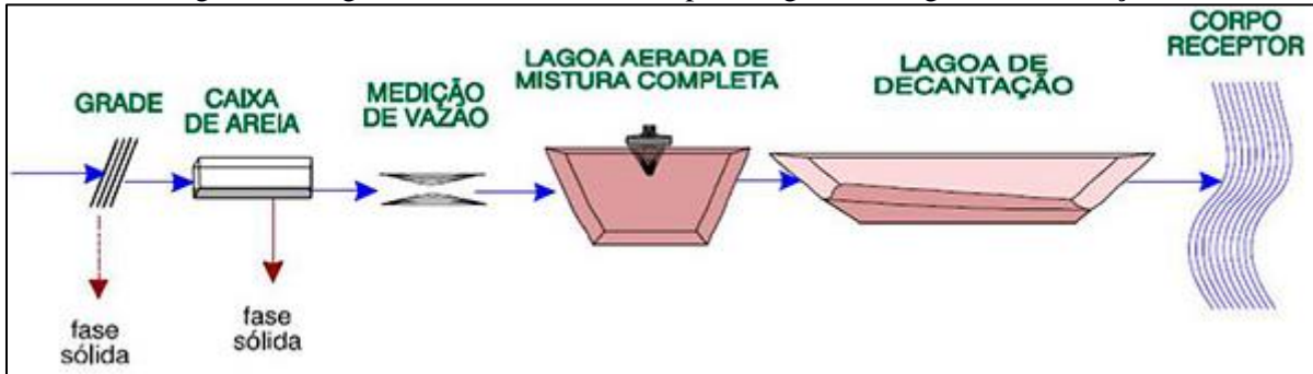
Figura 60. Lagoa aerada de mistura completa seguida de lagoa de decantação
