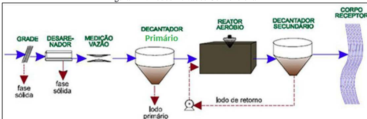
Figura 124. Lodos Ativos Convencional
