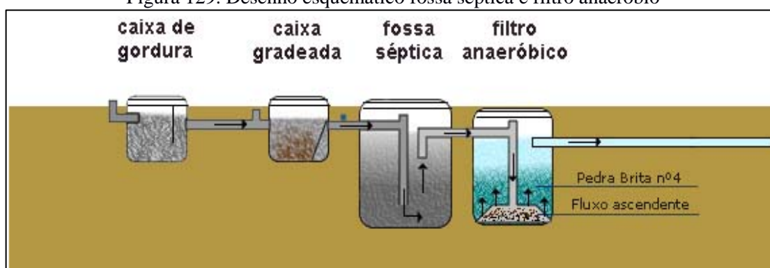
Figura 129. Desenho esquemático fossa séptica e filtro anaeróbio
