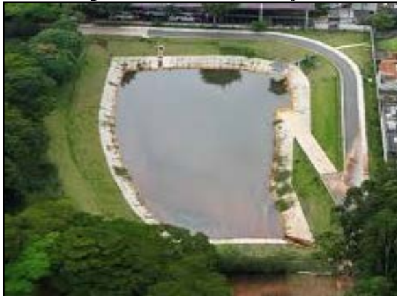
Figura 146. Bacia de detenção
