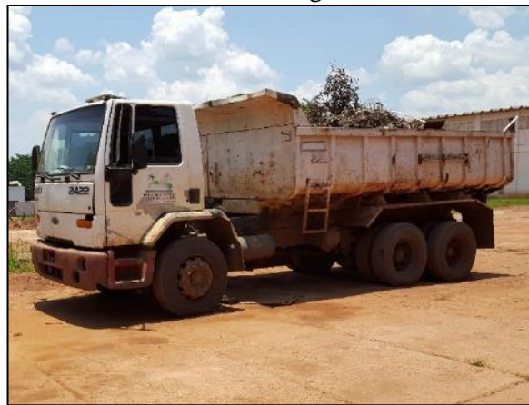
Figura 78. Caminhão basculante de 15m 3 utilizado na coleta de resíduos na cidade de Barra do Bugres
