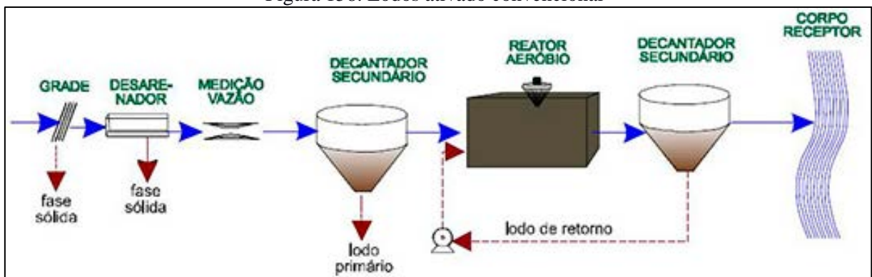
Figura 158. Lodos ativado convencional
