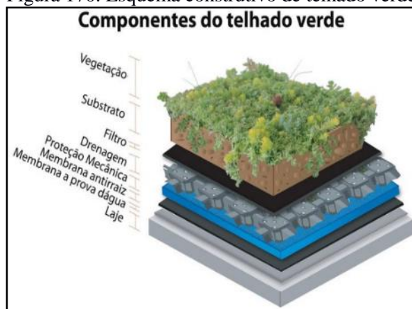
Figura 170. Esquema construtivo de telhado verde
