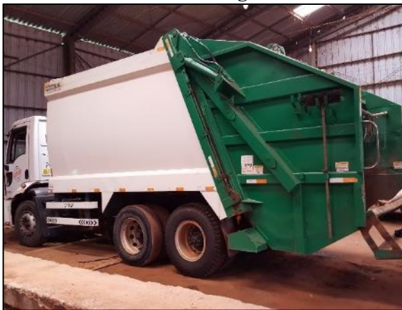
Figura 77. Caminhão compactador de 15m 3 utilizado na coleta de resíduos na cidade de Barra do Bugres
