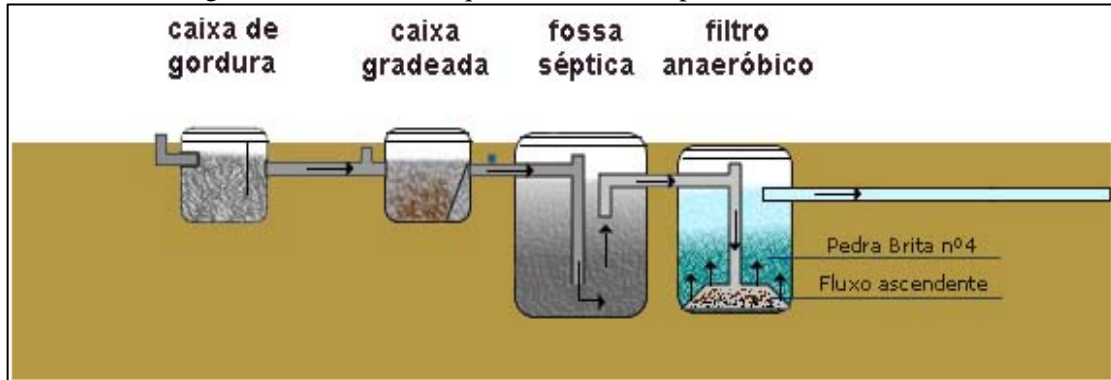
Figura 163. Desenho esquemático fossa séptica e filtro anaeróbio
