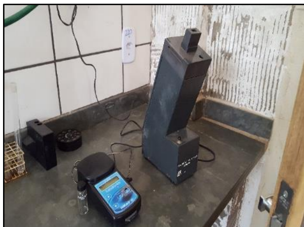
Figura 43. Turbidímetro e medidor de cor no laboratório da ETA
