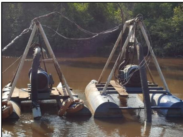
Figura 14. Mangotes flexíveis com diâmetro de 200 mm
