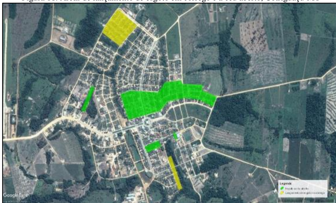
Figura 18. Áreas de lançamento de esgoto em córrego e a céu aberto, Cotriguaçu-MT
