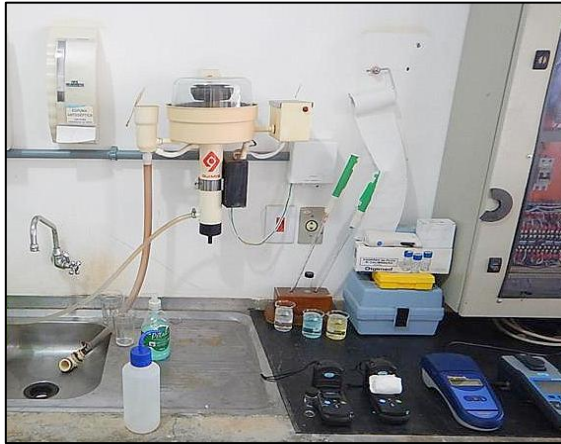
Figura 45. Destilador de água, colorímetros e turbidímetro do laboratório da ETA de Canarana-MT
