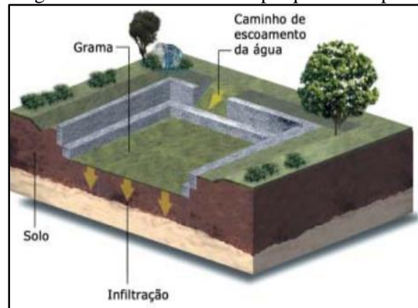
Figura 169. Reservatório em parque municipal
