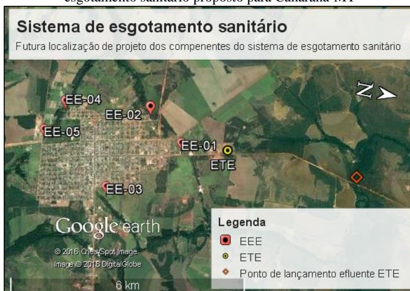
Figura 51. Localização das estações elevatórias e da estação de tratamento de efluentes do sistema de esgotamento sanitário proposto para Canarana-MT
