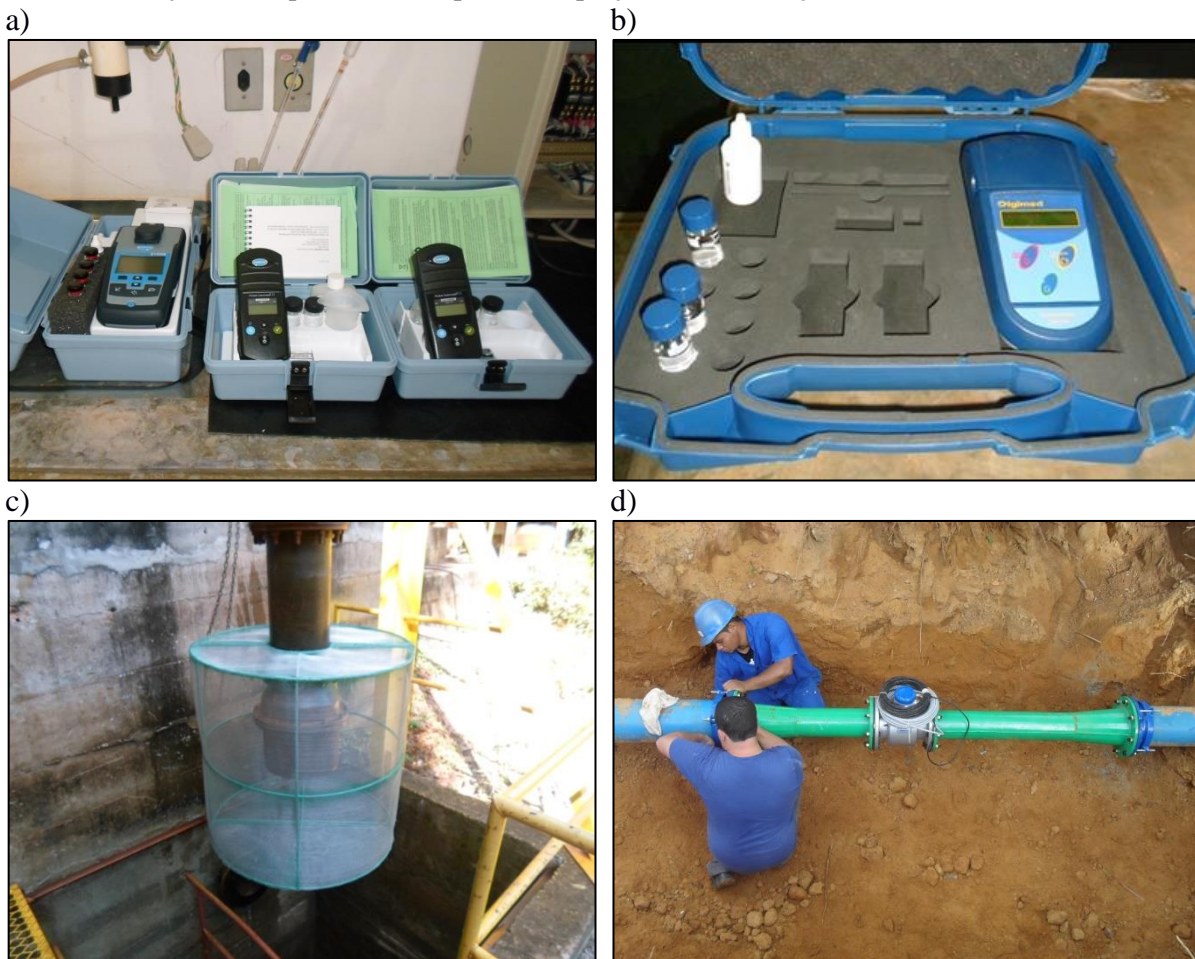
Figura 50. Equipamentos de laboratório de qualidade da água adquiridos (a e b), cesto instalado para diminuição da frequência de limpeza na captação (c) e instalação de macromedidores (d)
