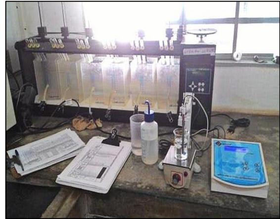
Figura 46. Aparelho Jar-Test e pHmêtro microprocessado do laboratório da ETA de Canarana-MT
