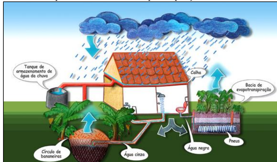
Figura 154. Desenho esquemático da bacia de evapotranspiração e círculo de bananeiras
