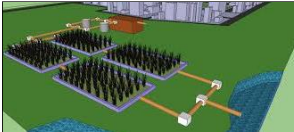
Figura 76. Sistema de tratamento individual utilizando zonas de raízes
