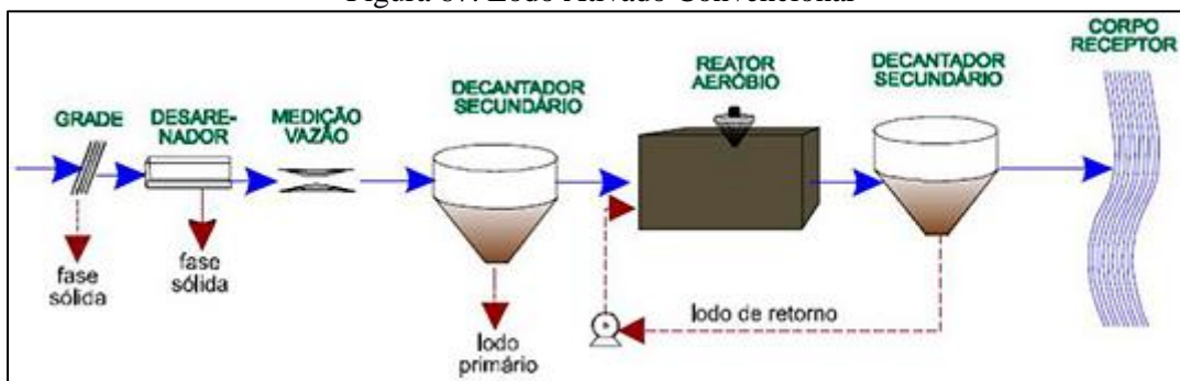
Figura 67. Lodo Ativado Convencional
