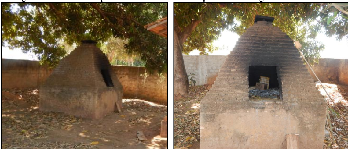
Figura 41. Fornalha de queima dos resíduos de serviços de saúde originados em Cocalinho-MT
