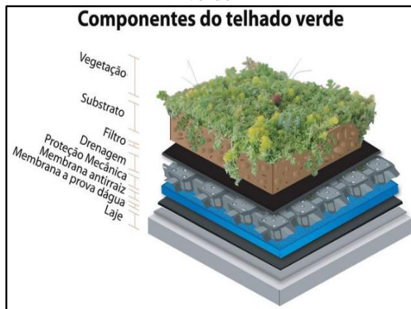
Figura 79. Esquema construtivo de telhado verde
