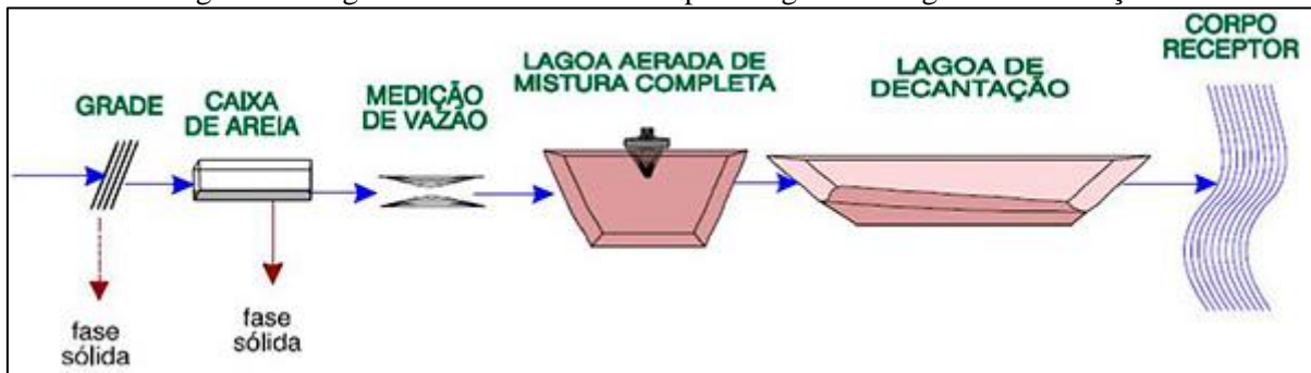
Figura 66. Lagoa aerada de mistura completa seguida de lagoa de decantação
