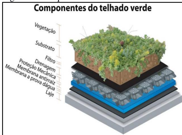
Figura 122. Esquema construtivo de telhado verde
