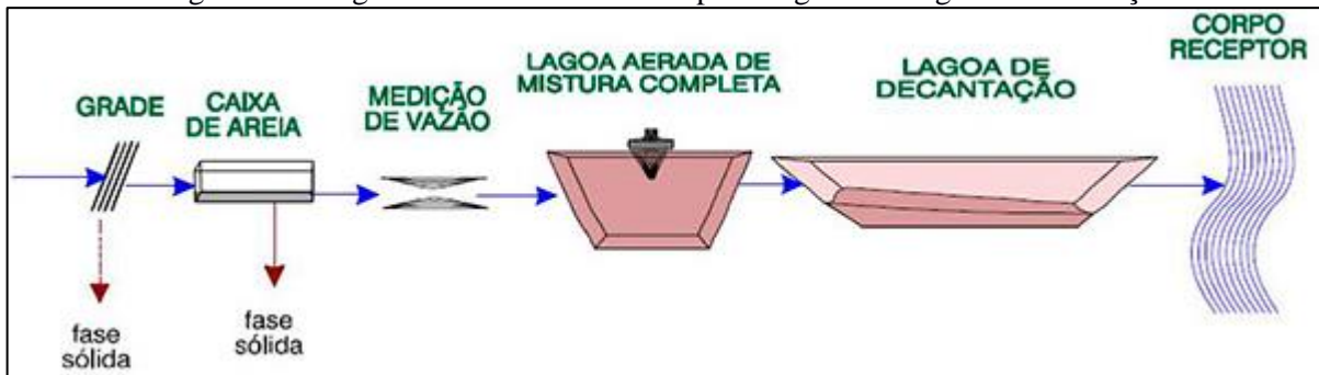
Figura 109. Lagoa aerada de mistura completa seguida de lagoa de decantação
