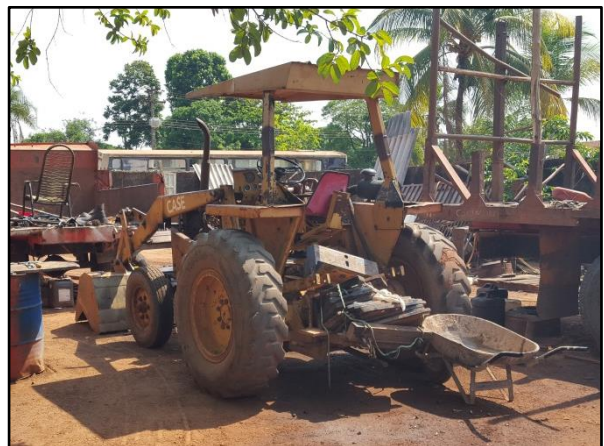
Figura 83. Pá carregadeira utilizado na coleta de RCD
