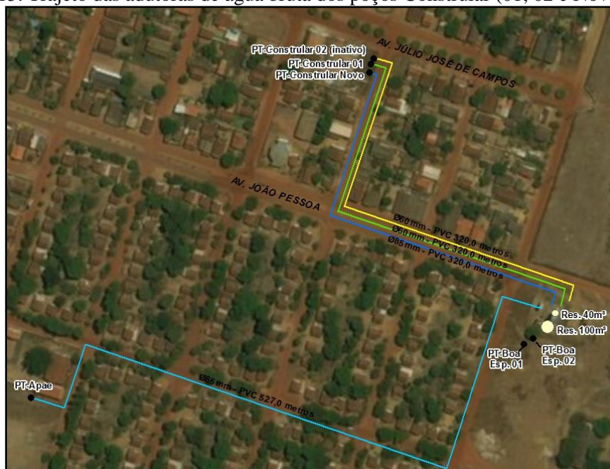
Figura 15. Trajeto das adutoras de água bruta dos poços Constrular (01, 02 e Novo) e Apae
