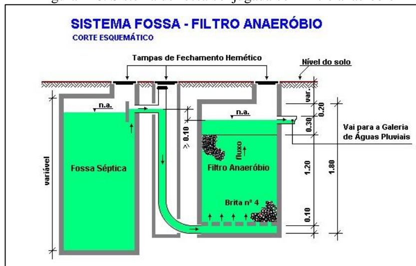
Figura 118. Sistema de fossa conjugada com filtro anaeróbio
