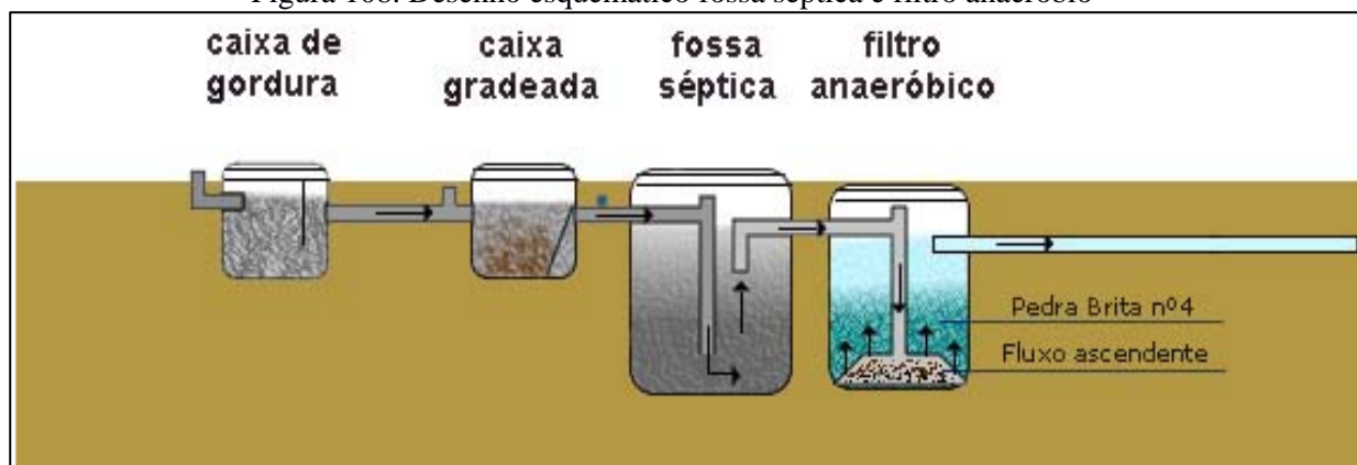
Figura 108. Desenho esquemático fossa séptica e filtro anaeróbio
