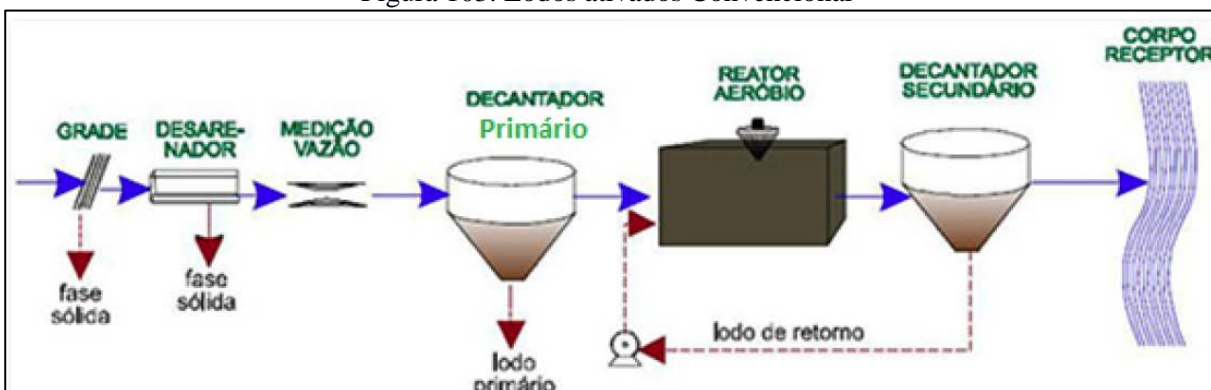
Figura 103. Lodos ativados Convencional
