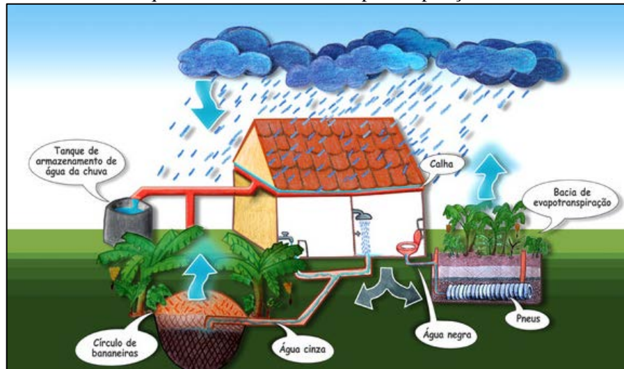
Figura 85. Desenho esquemático da bacia de evapotranspiração e círculo de bananeiras
