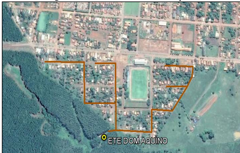
Figura 22. Rede coletora de Dom Aquino
