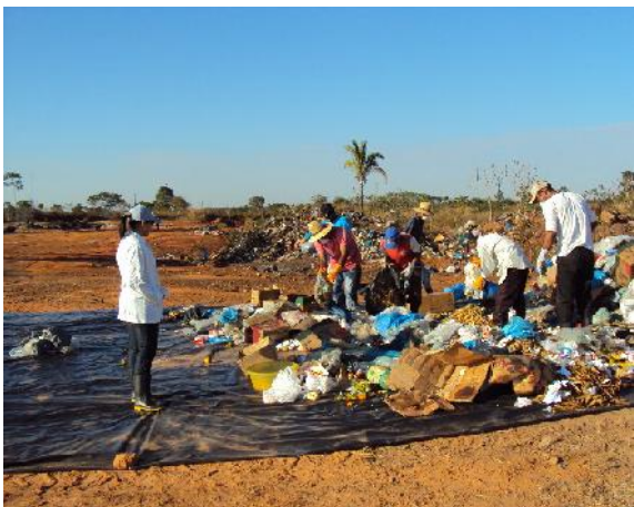
Figura 38 - Resíduos sólidos depositados sobre a lona e rompimento dos sacos para homogeneização (PGIRS, 2013).
