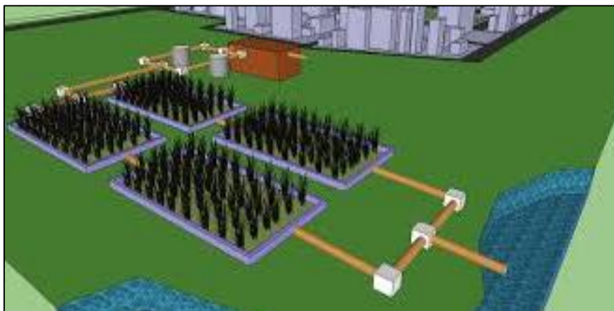
Figura 82. Sistema de tratamento individual utilizando zonas de raízes
