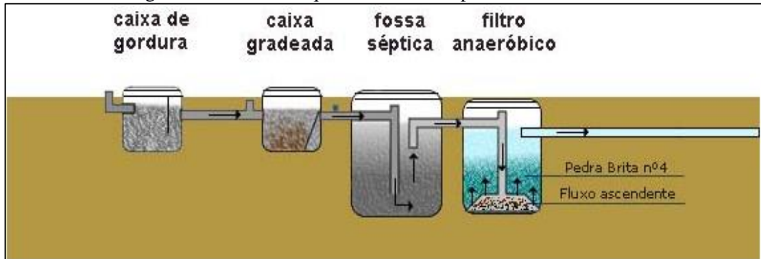
Figura 78. Desenho esquemático fossa séptica e filtro anaeróbio
