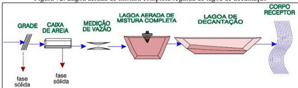
Figura 72. Lagoa aerada de mistura completa seguida de lagoa de decantação
