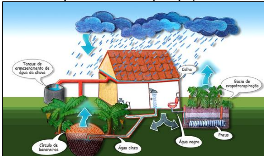
Figura 81. Desenho esquemático da bacia de evapotranspiração e círculo de bananeiras
