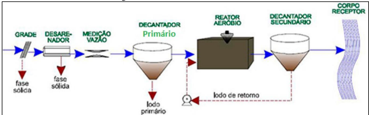
Figura 73. Lodo Ativado Convencional
