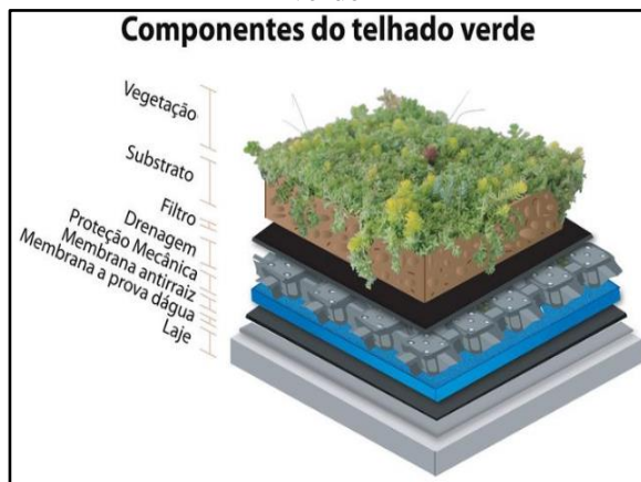
Figura 90. Esquema construtivo de telhado verde
