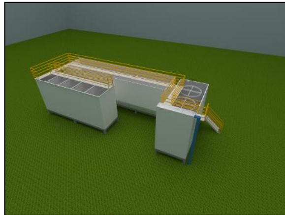
Figura 14. Layout do sistema de tratamento de água de Guarantã do Norte ETA - 1 ETA - 2
