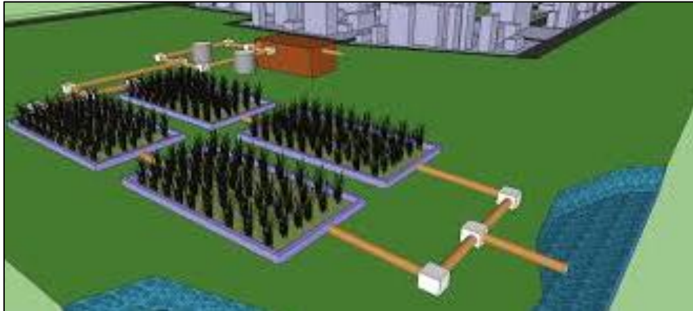
Figura 87. Sistema de tratamento individual utilizando zonas de raízes
