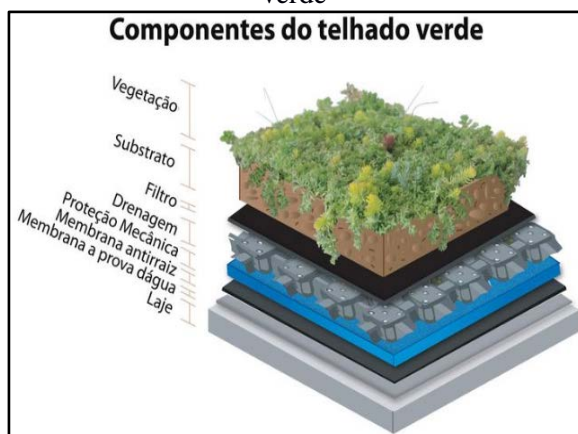
Figura 104. Esquema construtivo de telhado verde
